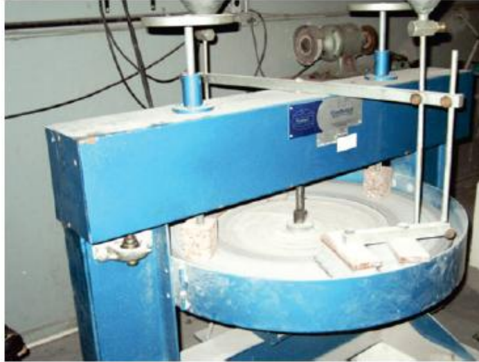
Figura 13- Equipamento de desgaste abrasivo do tipo Amsler (Costa et al. , 2014)
