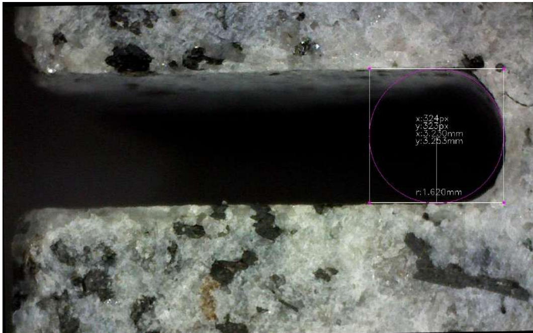
Figura E.3 – Foto da medição do raio do CP 201 da serra T 2,4 mm. Fonte: o autor.
