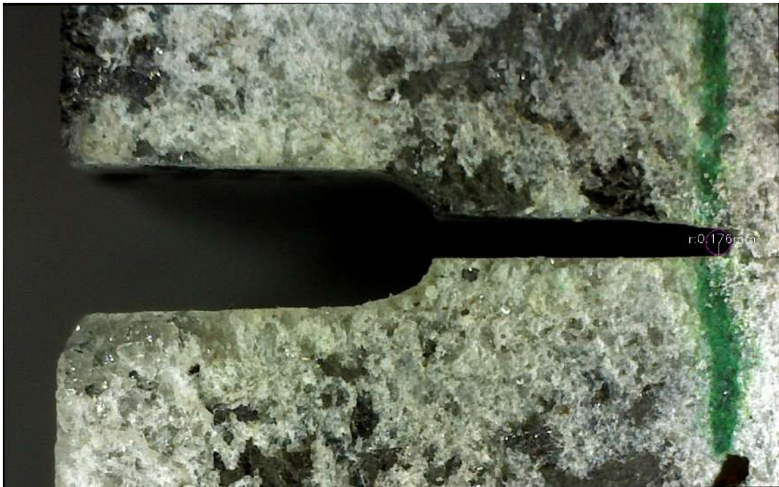
Figura 4.15 – Análise da foto do entalhe produzido no CP109 pelo disco de T 0,3 mm utilizando o software desenvolvido durante esta pesquisa. Fonte: o autor.
