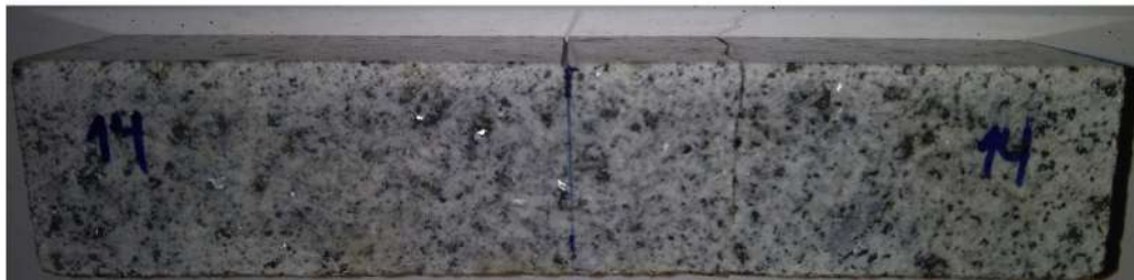
Figura 4.37 – Foto do CP com fratura na superfície fora do entalhe criado. Fonte: o autor.
