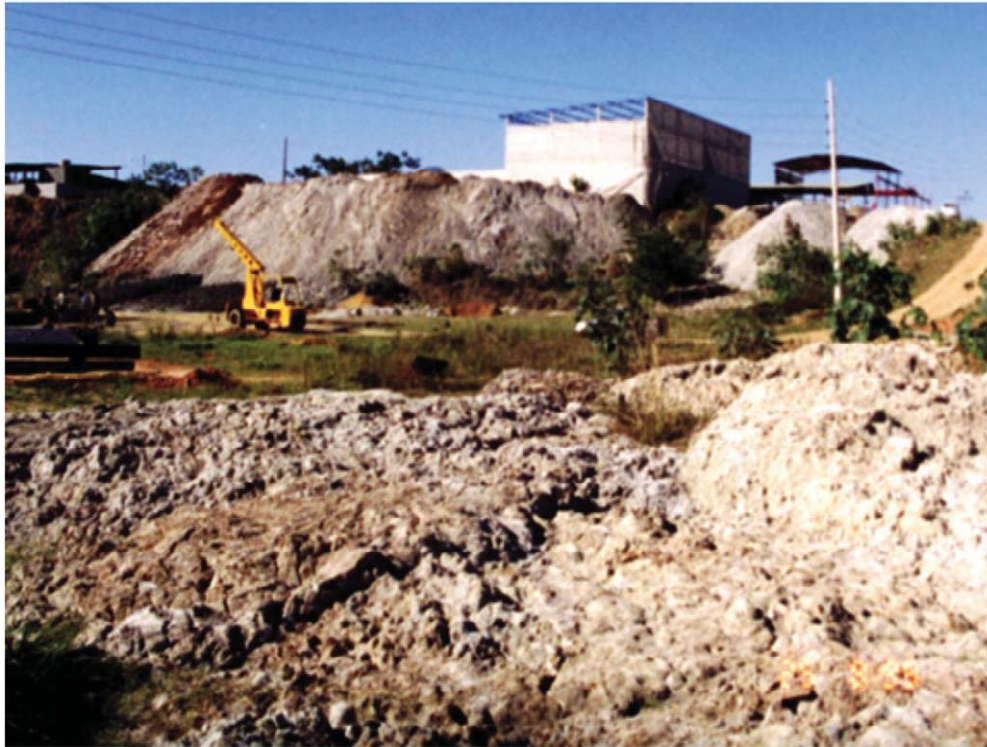
Figura 2.9 – Acúmulo de rejeitos de forma aleatória em primeiro plano de fundo, de uma serraria no bairro Aeroporto, Cachoeiro do Itapemirim (Mothé Filho et al. , 2005).
