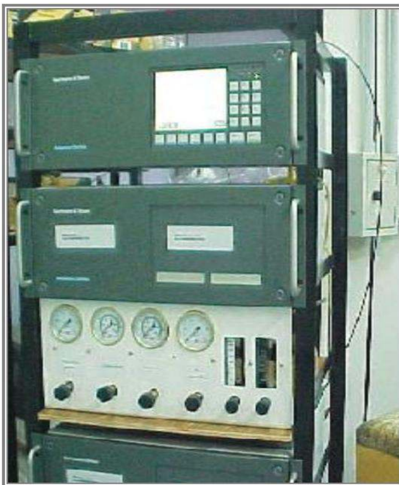
Figura 5.6 – Vista Frontal do URAS 14, Utilizado na Identificação dos Compostos Gasosos
