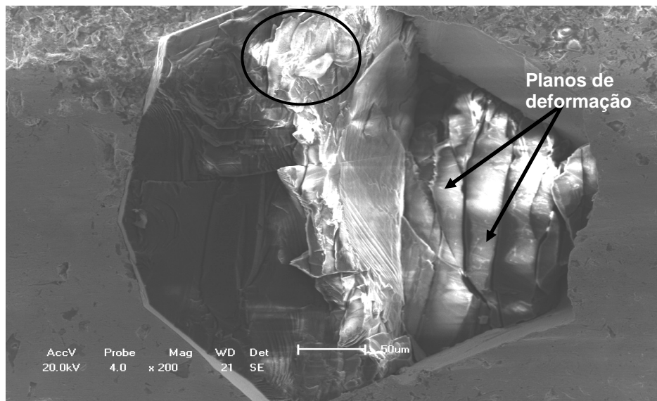
Figura 4.7 – Micrografia mostrando a clivagem (quebra) de um cristal de diamante após ensaio de desgaste por abrasão para o compósito M1 – 65%pFe-15%pCu-20%pCo – 2 minutos .
