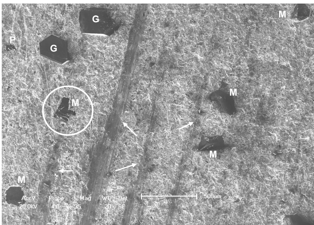
Figura 4.43 – Distribuição dos diamantes em função da classificação por tamanho, para o compósito M2 – 50%pFe-30%pCu-20%pCo-Diamante, após abrasão a 6 minutos.
