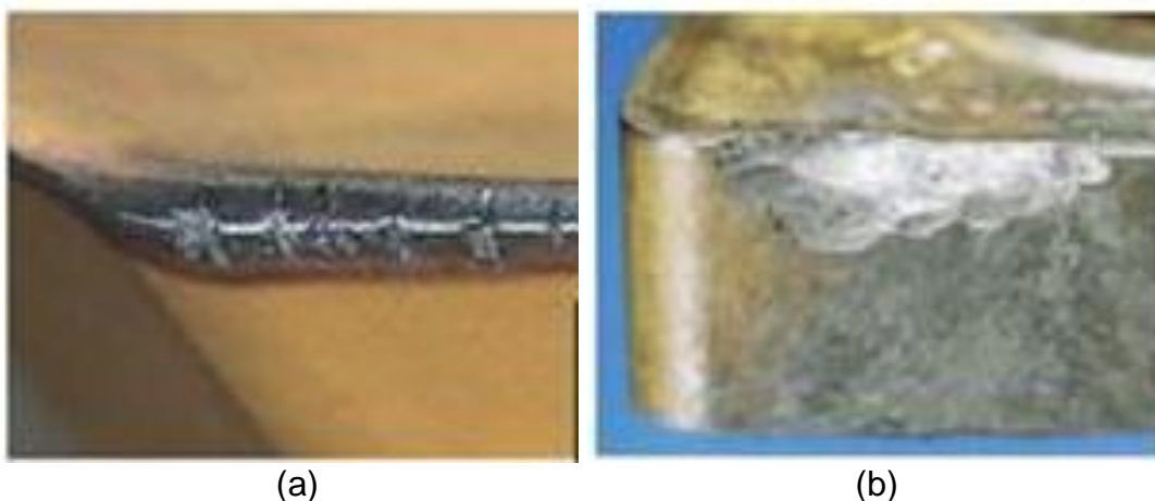
Figura 4.23. Avarias em ferramenta de corte. a) Trincas térmicas b) Lascamento/quebra (Sandvik Coromant, 2014).
