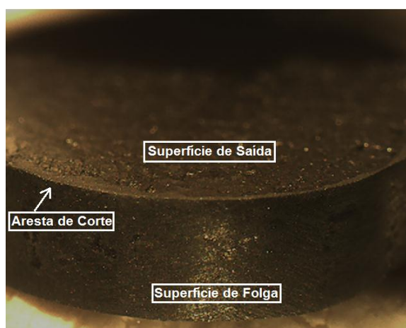
Figura 6.30. Aresta de corte antes do processo de usinagem.
