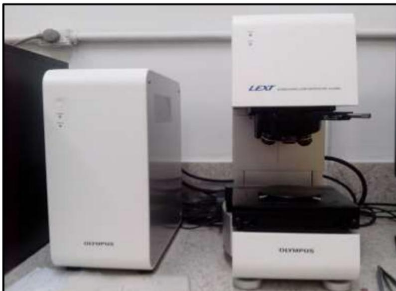
**Figura 16:** Microscópio Confocal (marca Olympus Modelo LEXT OL S4000).
