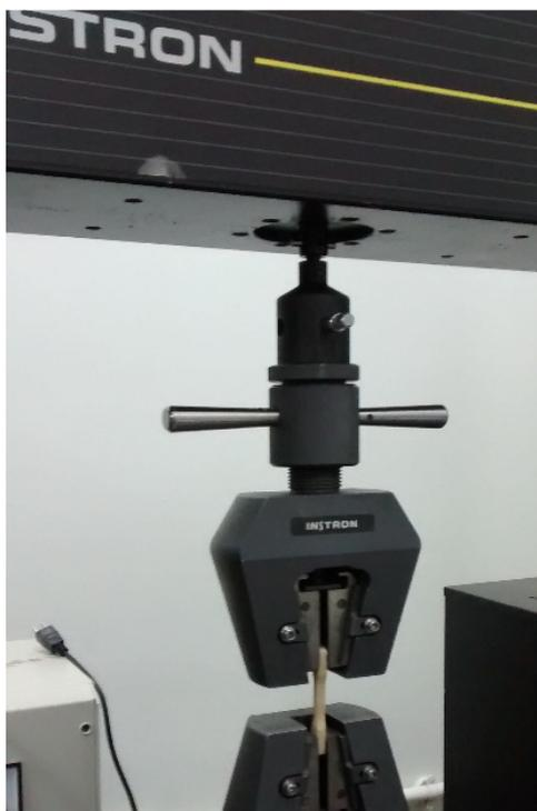
**Figura 15:** Detalhe da Máquina de ensaio (marca Instron modelo 5582).
