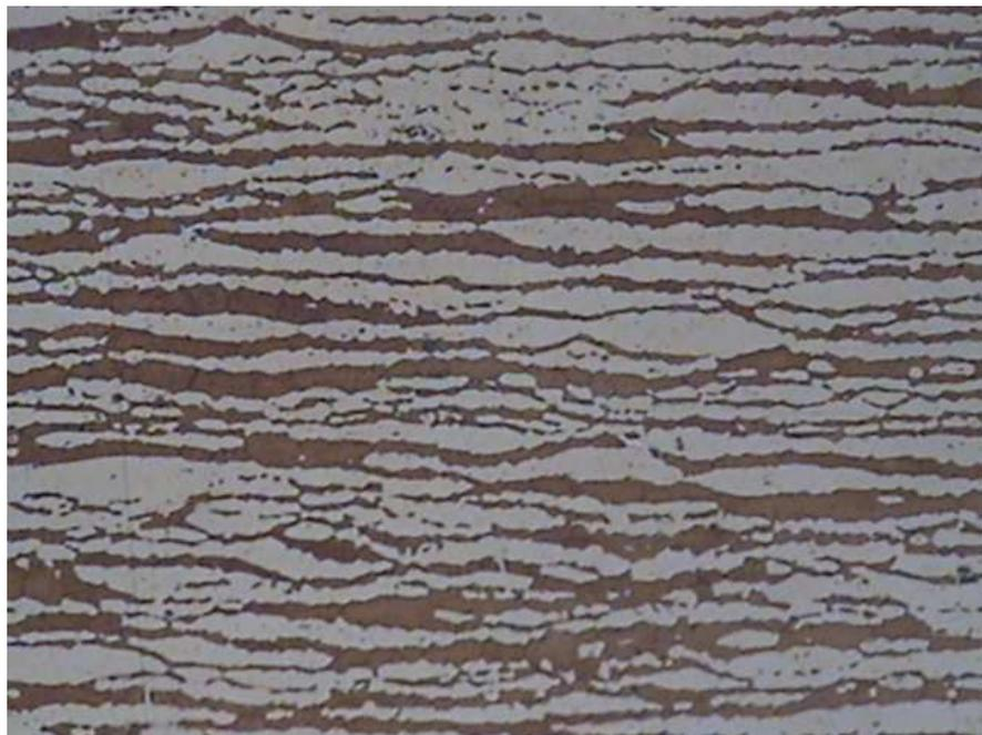
Figura 32: Micrografia óptica do metal de base do AISD mostrando a quantidade aproximadamente igual de austenita (região atacada clara) e ferrita (região atacada escura) (200x).
