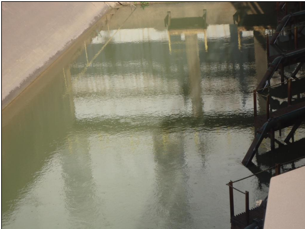
Figura 4.6 – Bacia de decantação para separação de argila e areia.
