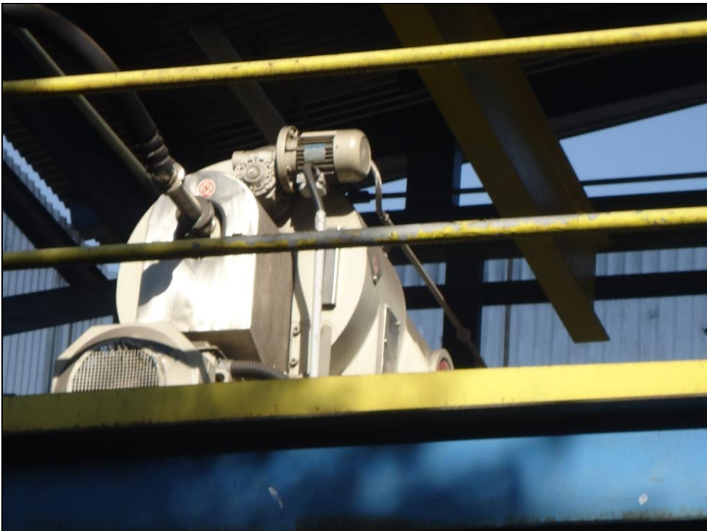
Figura 4.10 – Estação de centrifugação da lama floculada.
