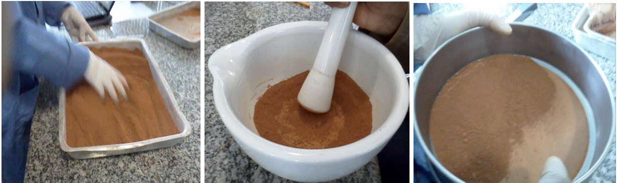
Figura 4.2: Imagens da lama vermelha: (a) após secagem; (b) sendo desagregadas e (c) em peneiramento.
