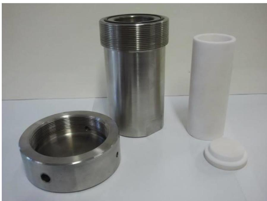
**Figura 17: Foto ilustrativa do reator utilizado para a síntese de magnetita.**
