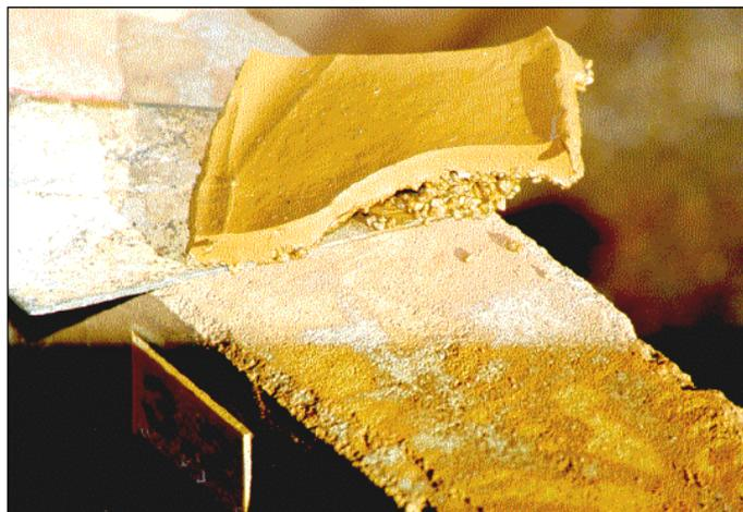
Figura 2.8 - Lodo desidratado do filtro prensa. Fonte: SABBAG e MORITA (2003).
