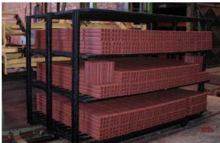
Figura - 2.11. Blocos cerâmicos produzidos com o lodo da ETA de Cubatão.
