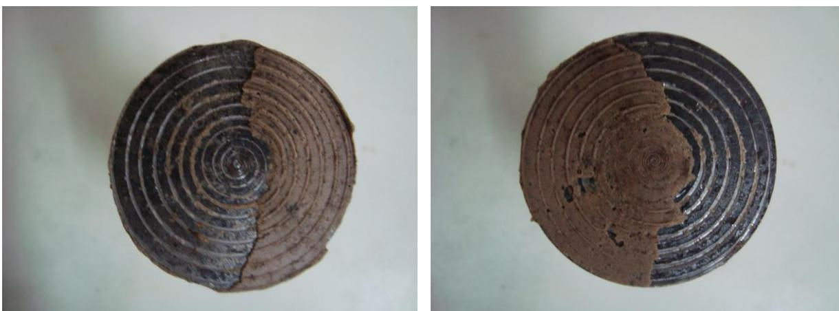
Figura 4.11: Aspecto da fratura da amostra revestida com geopolímero com 1% de wollastonita.
