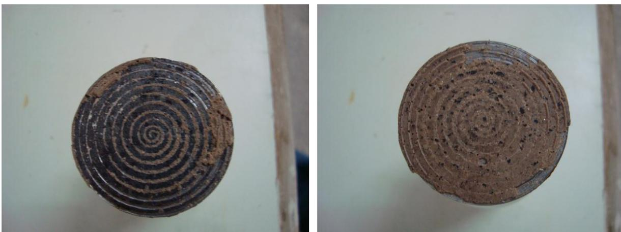
Figura 4.12: Aspecto da fratura da amostra revestida com geopolímero com 2% de wollastonita.
