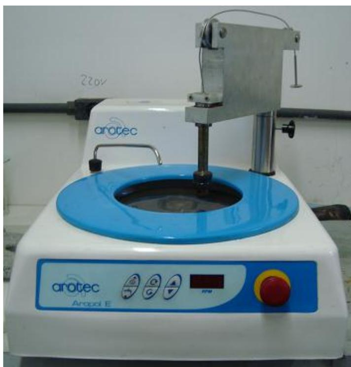
Figura 3.2: Abrasímetro utilizado para ensaio de abrasão nos corpos de geopolímero, modelo Aropol E, marca Arotec,
