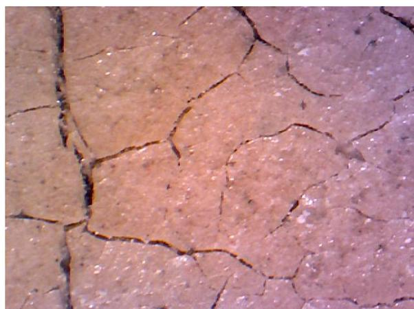
Figura 4.8: Imagens dos revestimentos com 0% (a), 1% (b) e 2% (c) de wollastonita após serem submetidos ao quinto ciclo térmico de 200°C.
