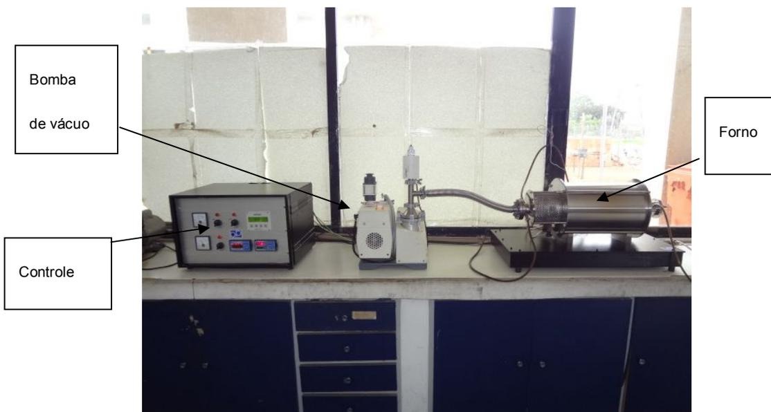
Figura 21. Forno de sinterização.
