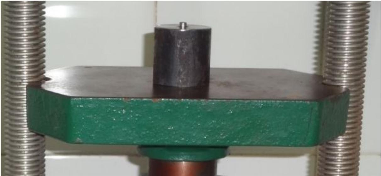
Figura 20. Prensa manual de 11 toneladas de capacidade.
