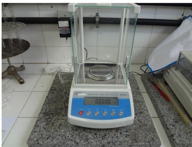
Figura 23. Balança de precisão Scaltec de resolução 0,0001g.
