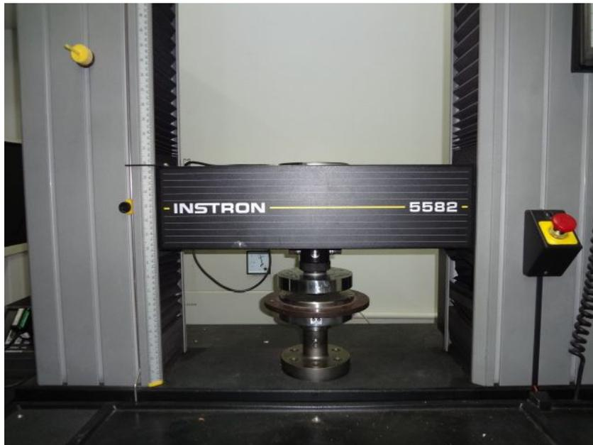
Figura 24. Máquina de ensaios de compressão monotônica.
