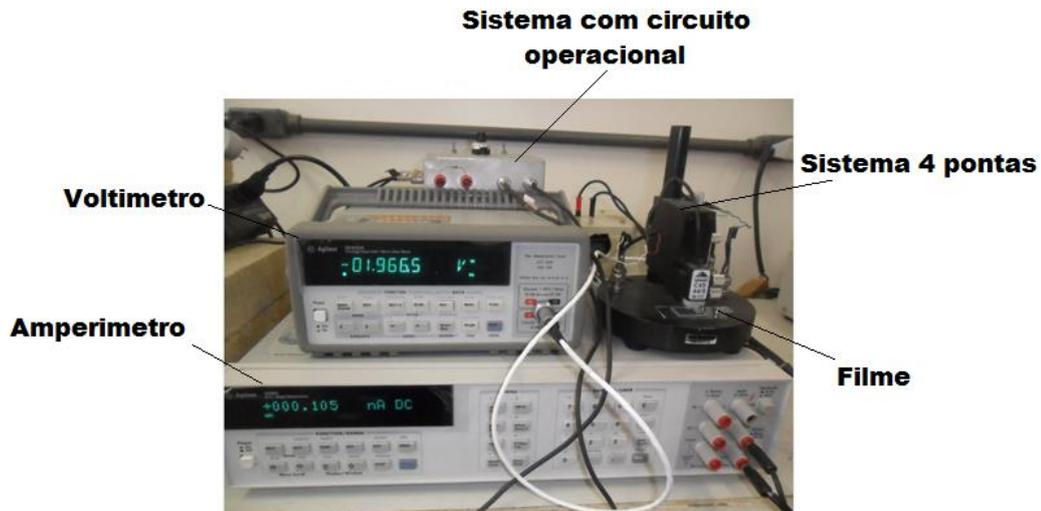
Figura 3.6 – Fotografia do sistema utilizado no método das quatro (4) pontas disponível na oficina de filmes do LAMAV.
