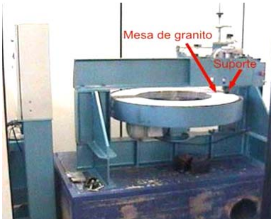
Figura 3.7 – Equipamento Abrasímetro microprocessador Modelo AB800-E da Contenco.
