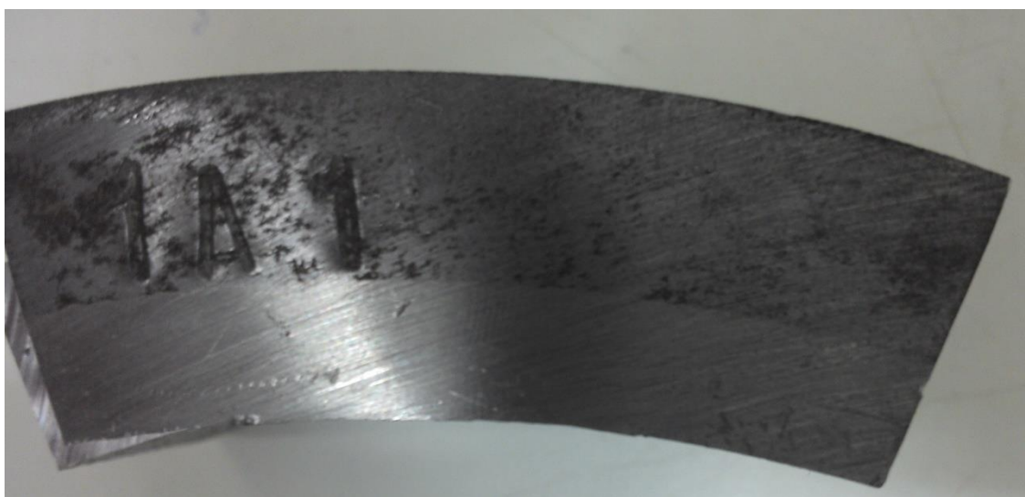
Figura 15. Arco retirado da seção transversal do tubo na condição como soldado.
