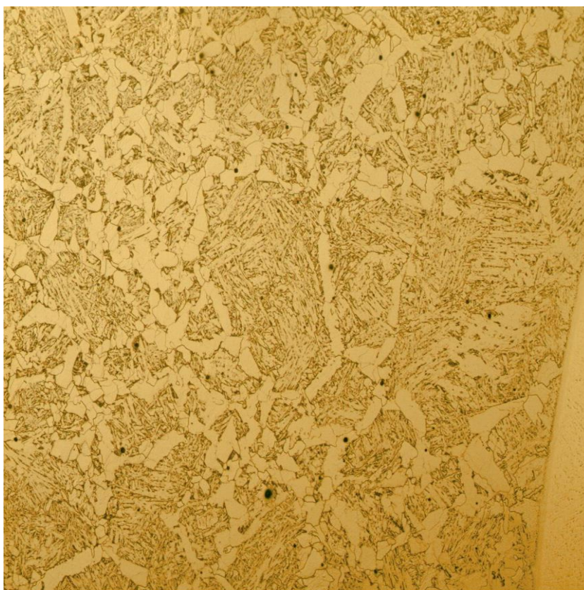
Figura 27: Microestrutura do MB normalizado a 1100°C por 60 minutos. MO: Olympus GX41. Aumento: 100X.
