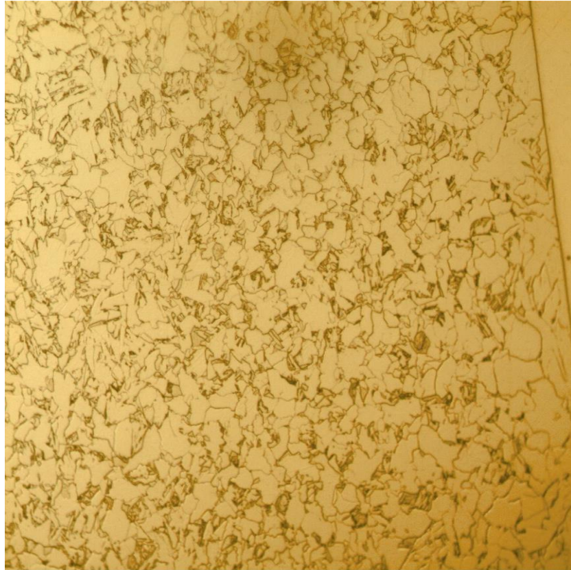
Figura 35: Microestrutura do MB solubilizado a 1030°C por indução. MO: Olympus GX41. Aumento: 500X.
