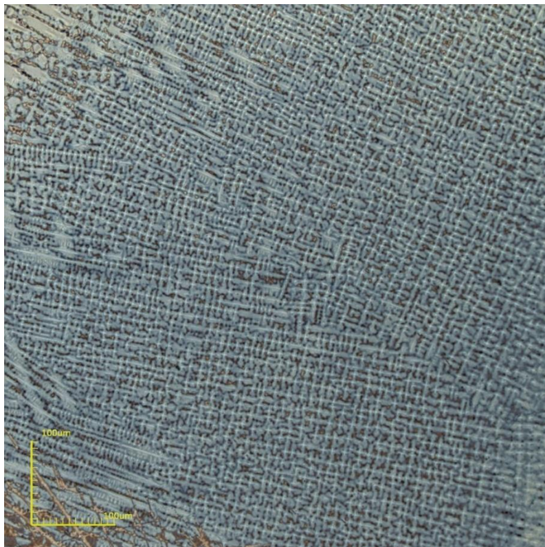
Figura 42: Microestrutura presente na quarta camada do revestimento de Inconel 625. Microscopia Confocal.
