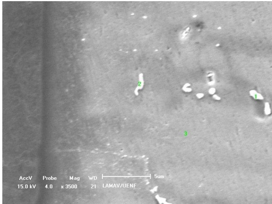
Figura 23: Micrografia obtida pelo MEV, com aumento de 3500X. Os pontos 1 e 2 indicam dois precipitados e o 3 a matriz de Inconel 625, onde foram feitas as análises por EDS.
