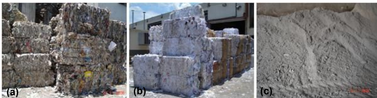
Figura 11 – Matérias-primas da indústria de papel reciclado (a) e (b) papéis diversos, (c) lodo primário de ETE da indústria de celulose.
