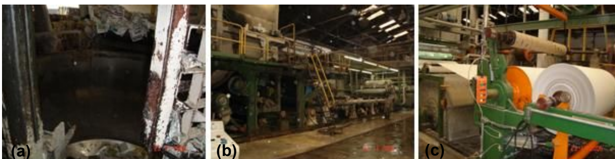
Figura 12 – Processo de fabricação do papel (a) desintegração da matéria-prima, (b) máquina de papel, (c) formação da folha.
