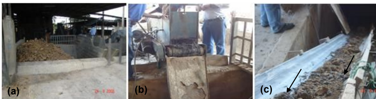
Figura 14 – (a) Caixão alimentador com a massa cerâmica argilosa; (b) dosador do lodo; (c) esteira transportadora com a massa argilosa e com o lodo.
