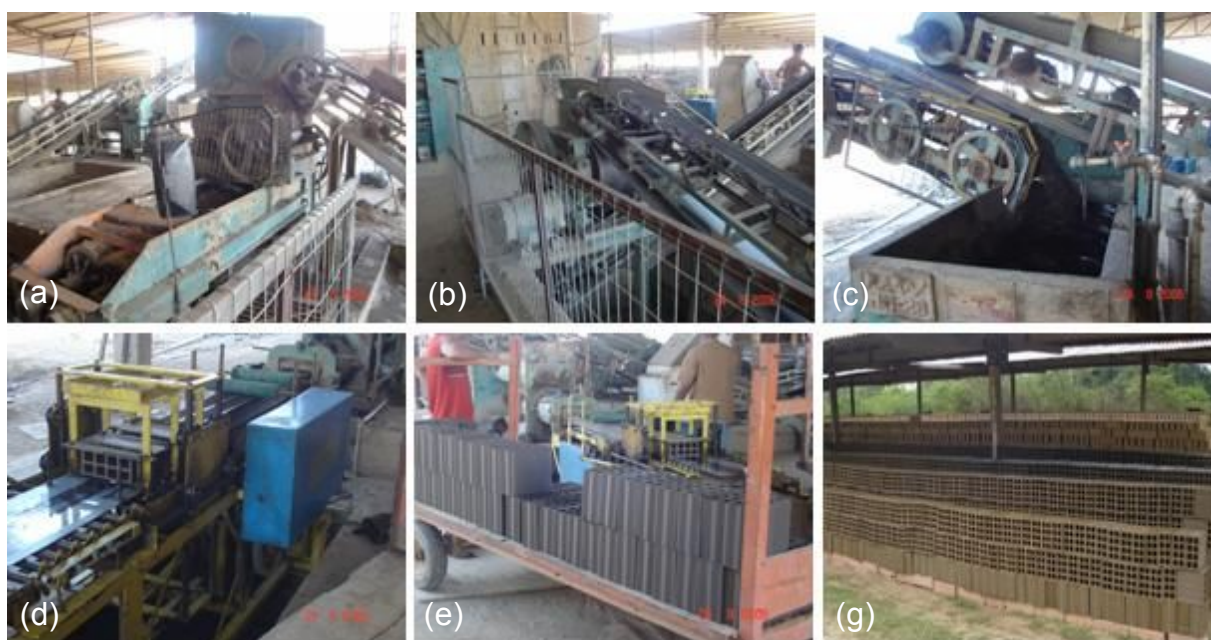
Figura 15 – Sequência de processamento da matéria-prima para a confecção dos blocos de vedação (a) desintegrador e homogeneizador; (b) laminador; (c) extrusora; (d) cortador; (e) blocos de vedação; (g) secagem.
