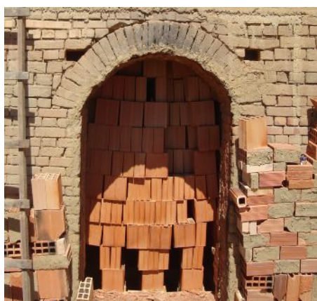
Figura 16 – Blocos de vedação já queimados dentro do forno industrial.
