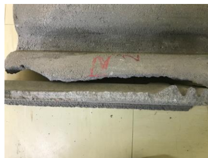
Figura 27: Ruptura da telha após ensaio
