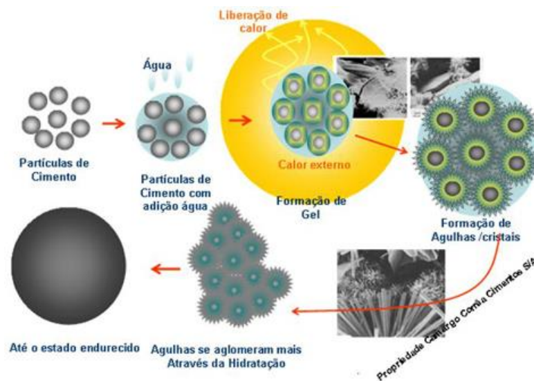
Figura 4: Processo de hidratação do cimento
