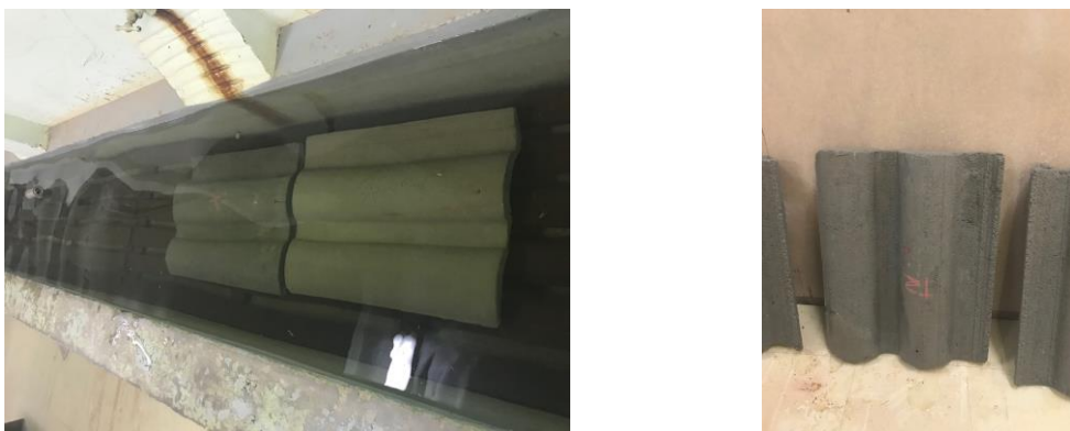
Figura 28: Ensaio de Absorção de água
