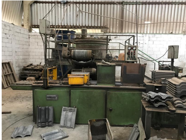
Figura 21:Maquinário completo para extrusão de telha de concreto.
