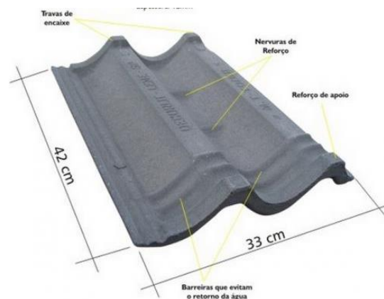
Figura 20: Dimensões da telha de concreto
