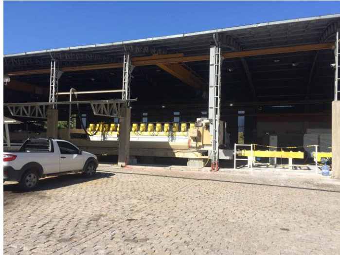
Figura 8: Processo de serragem dos blocos de mármore
