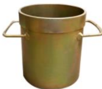
Figura 17: Aparato experimental para determinação da máxima densidade seca aparente.
