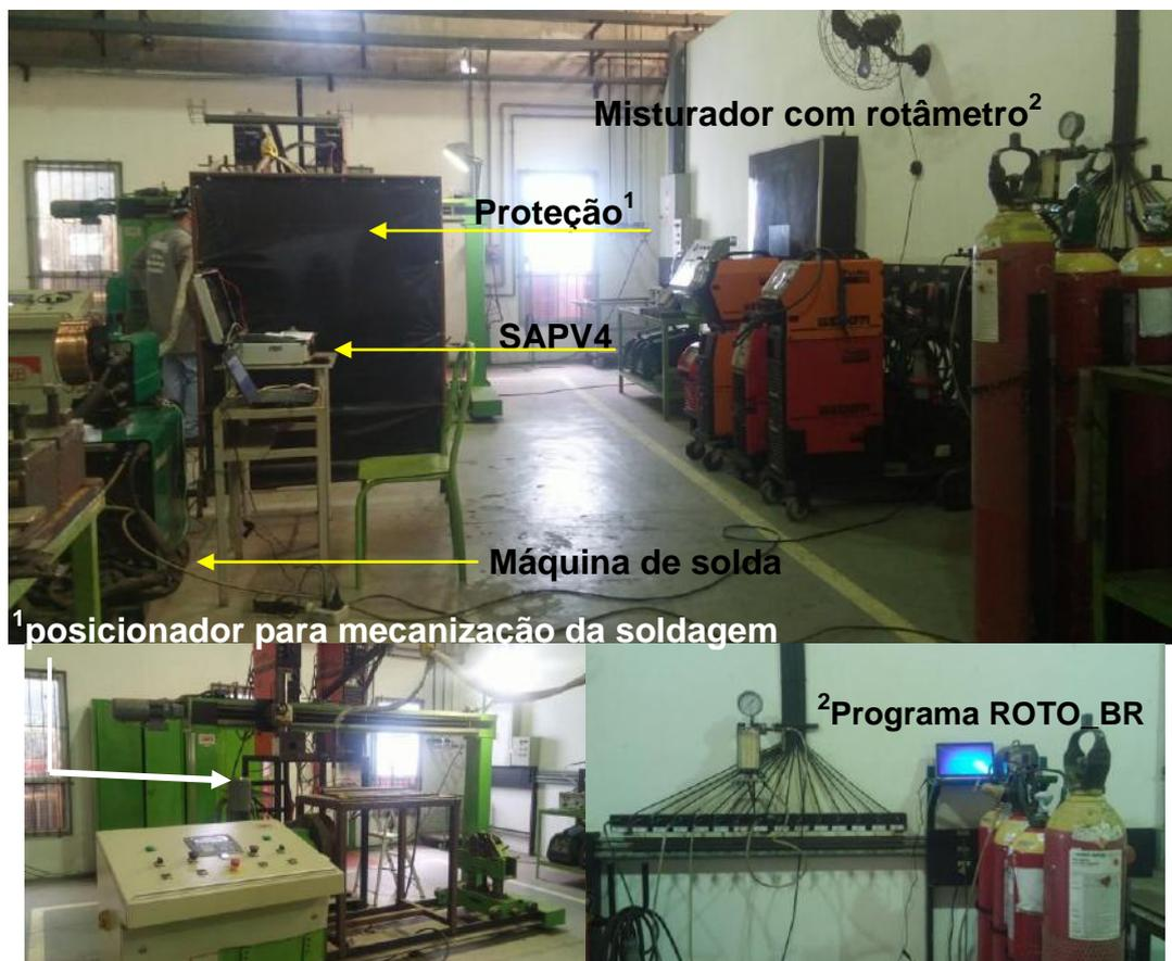
Figura 15: Equipamentos utilizados na realização da soldagem.
