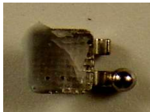
Figura 26 Parte de resina ortodôntica aderida á base do braquete, caracterizando uma falha do tipo coesiva.
