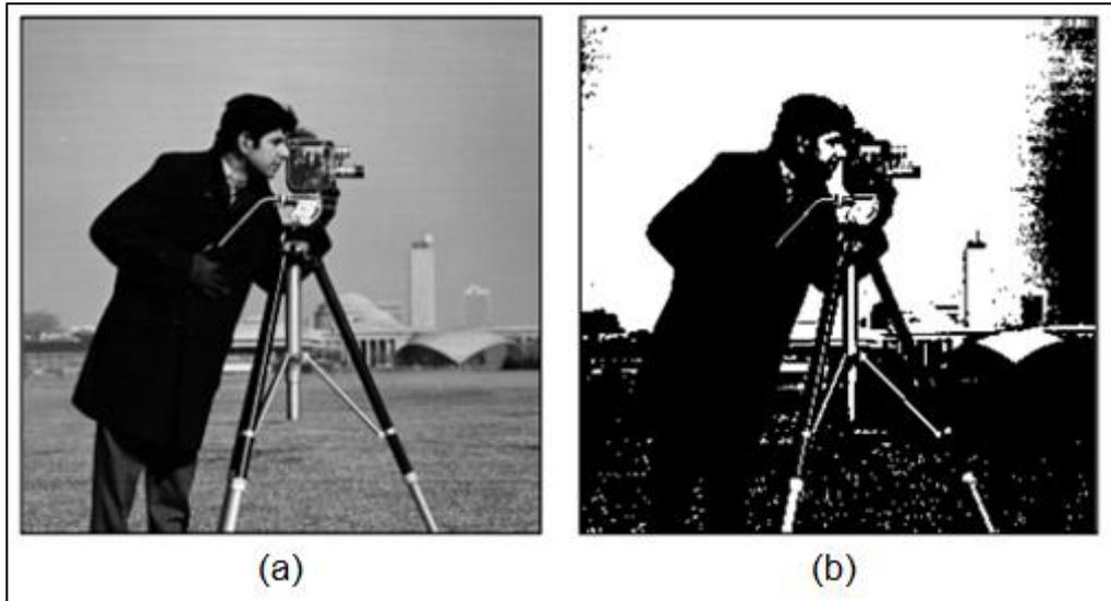
Figura 2.34 – a) Imagem original. b) Imagem com aplicação do algoritmo de limiarização com  $L$  igual a 127 (MELLO, 2013b).
