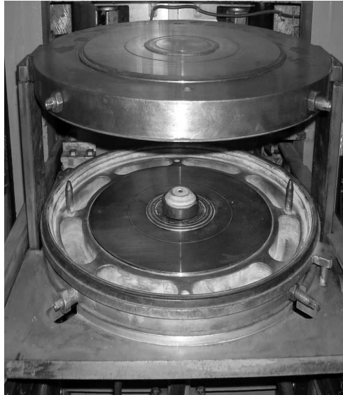
Figura 3.3 - Dispositivo de alta pressão (DAP) do tipo bigorna com concavidade central com a cápsula montada e instalada.
