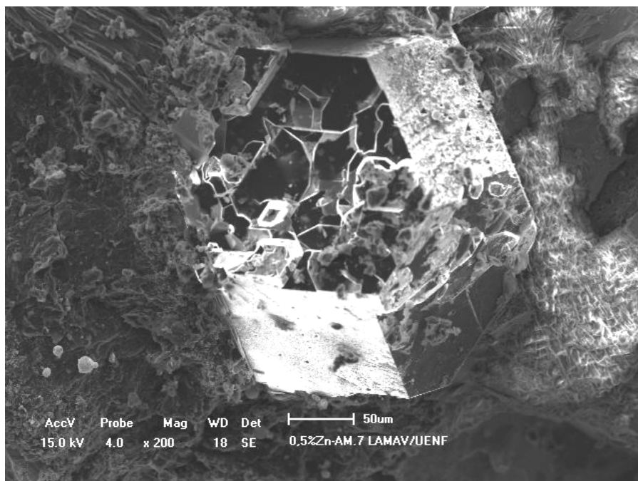
Figura 4.71 – Detalhe da superfície de um cristal exibindo marcas de crescimento em camadas (seis minutos de síntese).
