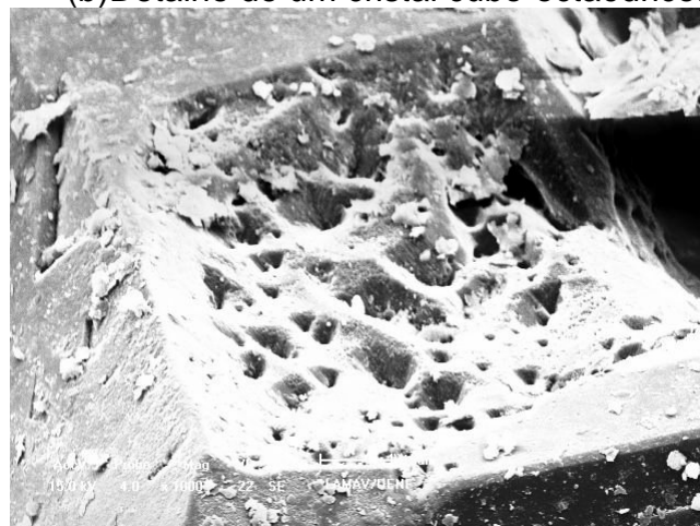
(c) Detalhe da superfície do cristal da figura 21(b).
