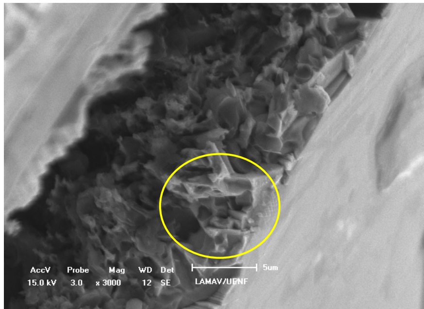
Figura 4.78 – Detalhe da região da interface grafite/metal/diamante destacada na figura 4.77.
