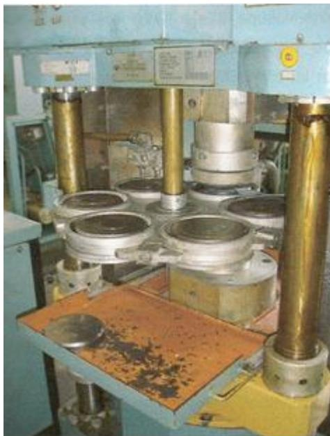
Figura 16 – Prensa de 630 ton detalhe do conjunto de dispositivos e cápsula deformável
