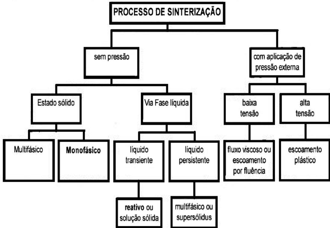
Figura 10. Fluxograma geral dos processos de sinterização (German, 1996).
