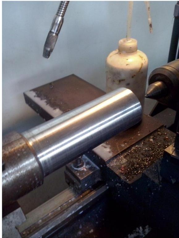
Figura 32 - Cilindro de aço 4140 submetido ao ensaio de torneamento
