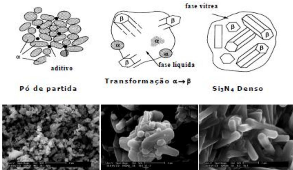
Figura 8: Esquema de transformação de fases  $\alpha \rightarrow \beta$  do nitreto de silício (Genova, 2003).
