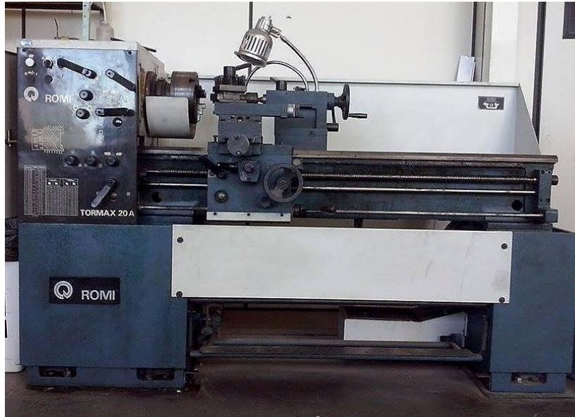
Figura 18 – Torno mecânico convencional - ROMI TORMAX 20A.
