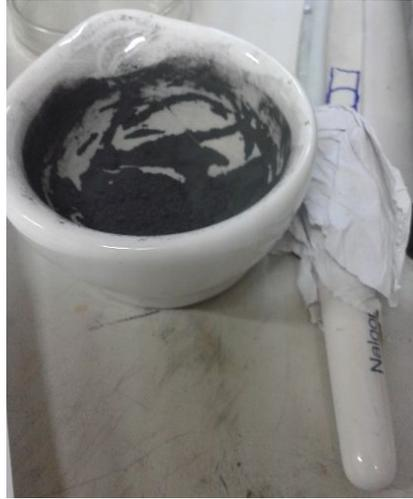
Figura 3.4 - Preparação da mistura de WC-10%Co, com almofariz e pistilo cerâmico.
