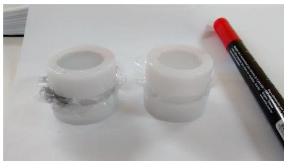
Figura 3.11 - Suporte do equipamento ED-XRF preenchido com o pó de WC Reciclado.
