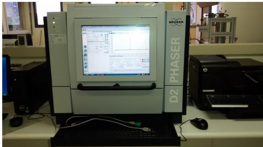
Figura 3.9 - Difratômetro de Raios X, marca Bruker, modelo D2 Phaser (LENEP).
