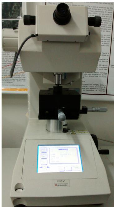
Figura 3.14 - Microdurômetro, marca Shimadzu, modelo HMV-2TE (LAMAV/UENF).
