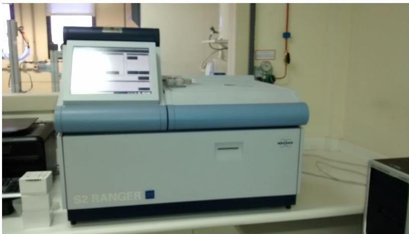
Figura 3.10 - Fluorescência de Raios X por Energia Dispersiva, marca Bruker, modelo S2 Ranger (LENEP).
