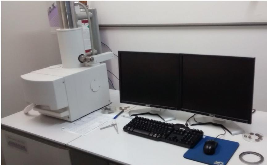
Figura 3.13 - Microscópio Eletrônico de Varredura (MEV/LAMAV/UENF).
