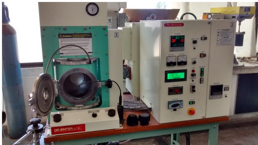
Figura 3.5 - Equipamento de Sinterização por Plasma Pulsado - Setor de Materiais de Alta Dureza (LAMAV – UENF).
