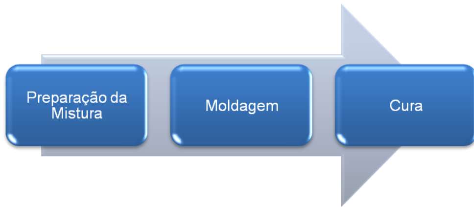
Figura 3.2. Fluxograma do processo de produção dos corpos de prova cilíndricos utilizando ABNT NBR 12024 (2012) – Solo-cimento – Método A adaptada.
