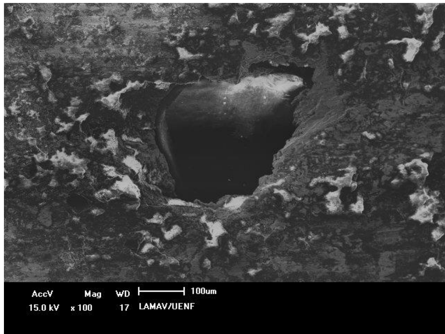
Figura 5.49: Afloramento do diamante na matriz Fe-Cu-Nb, após 2 minutos de ensaio de resistência à abrasão.
