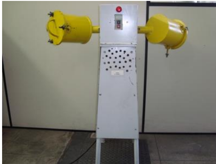
Figura 4.1: Misturador industrial para metais e diamantes.
