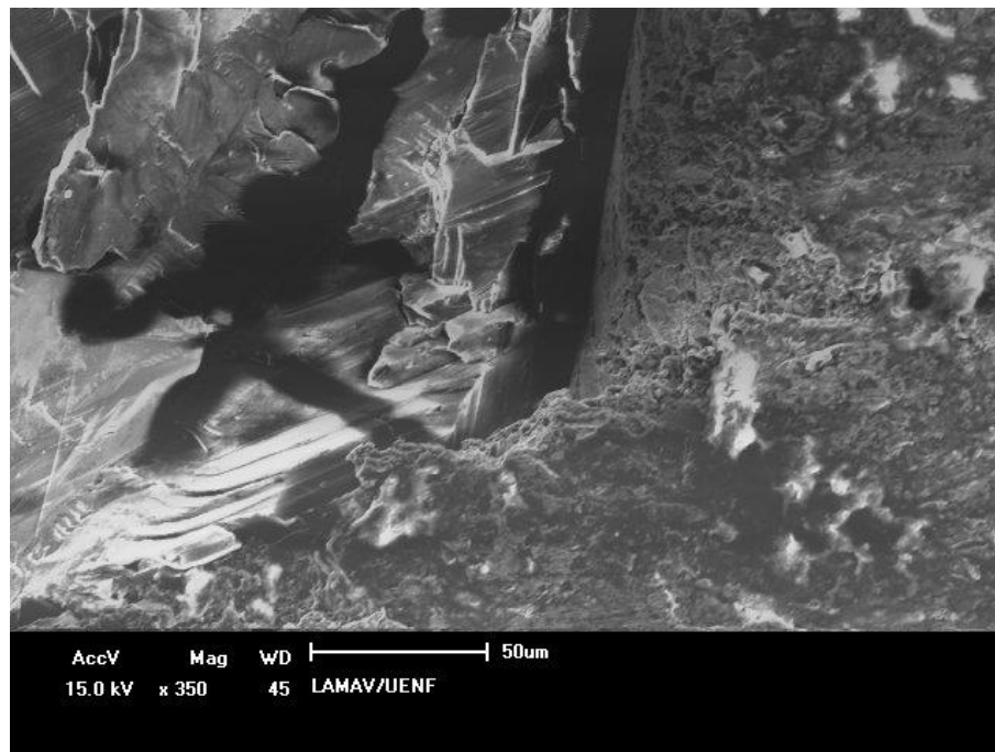
Figura 5.51: Estrutura do diamante com clivagem no compósito Fe-Cu-Nb, após 6 minutos de ensaio de resistência à abrasão.
