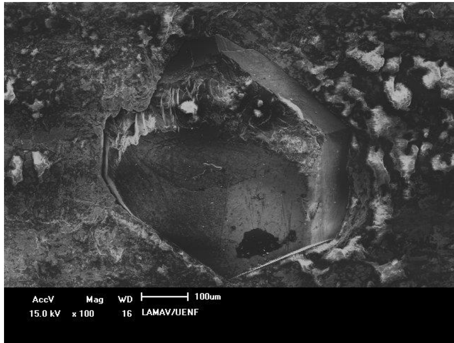
Figura 5.50: Estrutura do diamante com desgaste frágil no compósito Fe-Cu-Nb, após 2 minutos de ensaio de resistência à abrasão.
