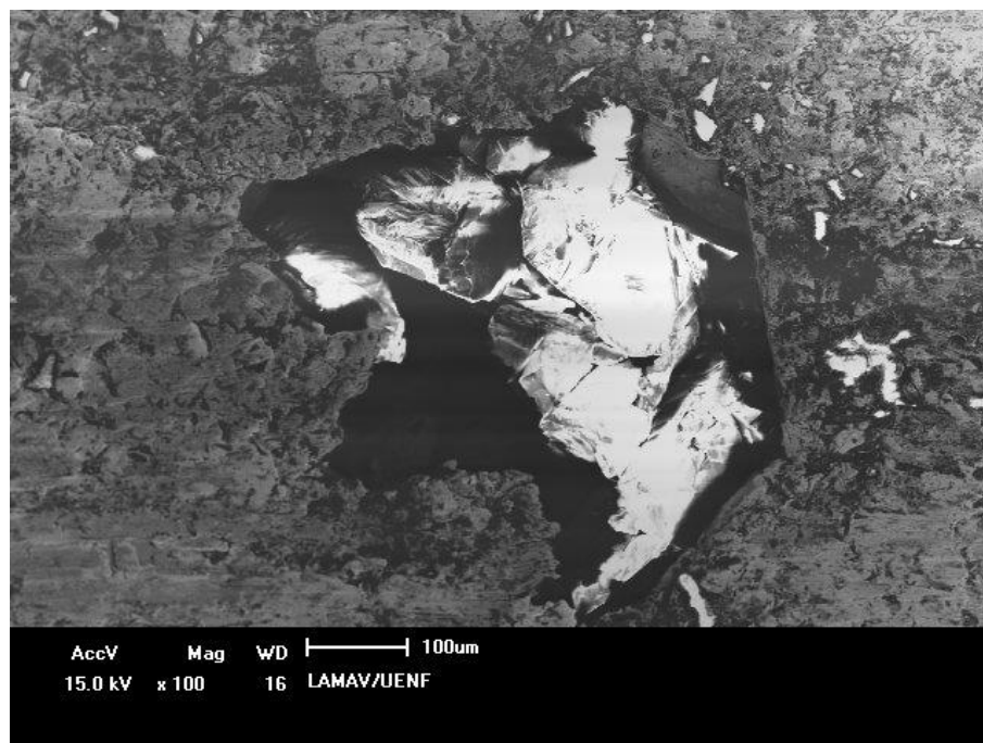
Figura 5.52: Estrutura do diamante no compósito Fe-Cu-Nb, após 6 minutos de ensaio de resistência à abrasão.
