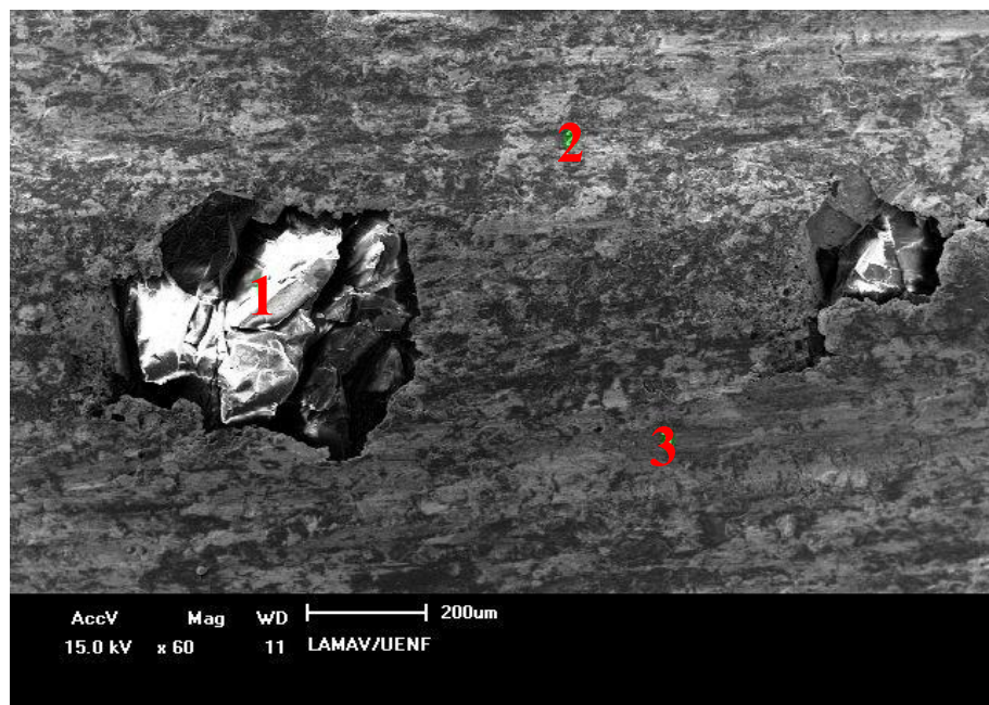
Figura 5.10: Microestrutura da liga Fe-Cu-Nb com a identificação das regiões da microanálise pontual por EDS.
