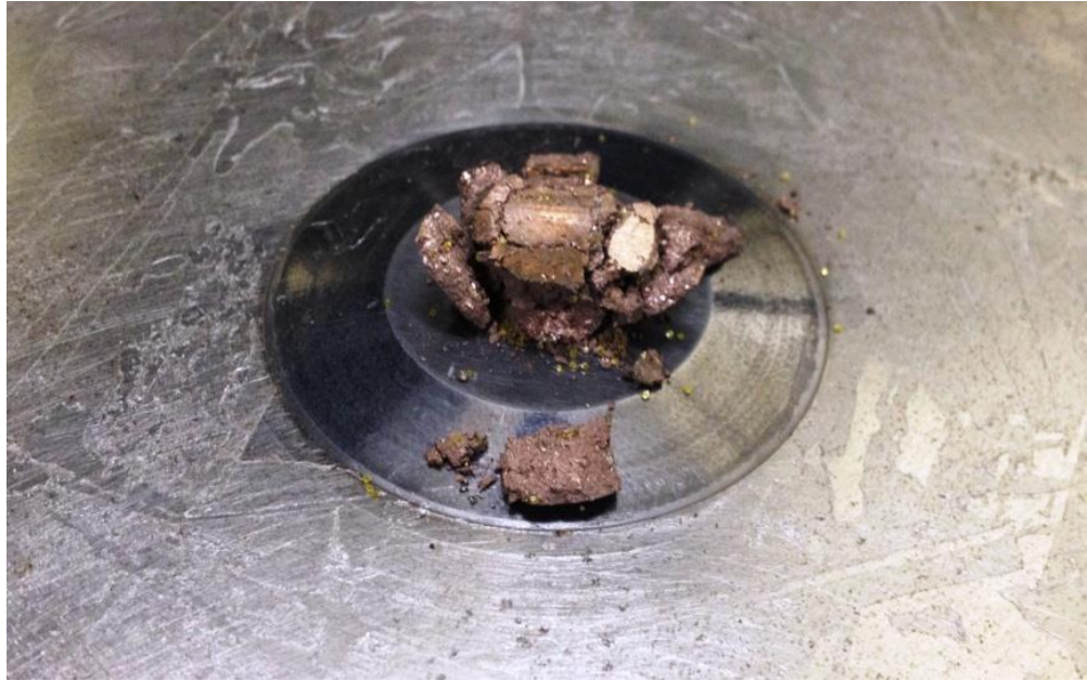
Figura 5.3: Amostra de Fe-Cu-Nb-Diamante após ensaio de compressão.
