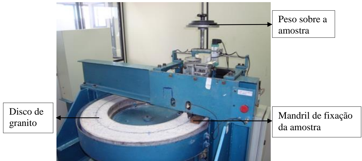
Figura 4.7: Simulador físico modificado (Abrasímetro).
