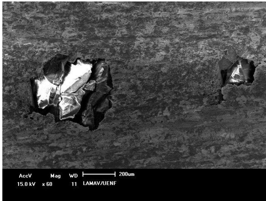
Figura 5.57: Estrutura dos cristais de diamante no compósito Fe-Cu-Nb, após 12 minutos de ensaio de resistência à abrasão.
