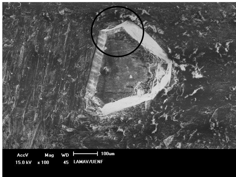
Figura 5.71: Estrutura do cristal de diamante no compósito DiabaseV-21, após 2 minutos de ensaio de abrasão.
