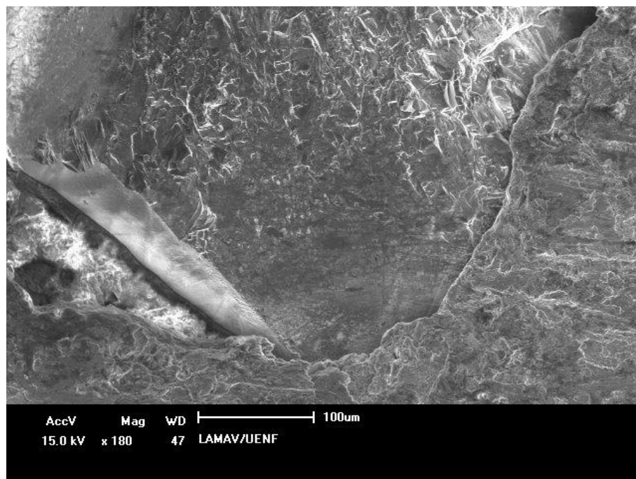
Figura 5.63: Estrutura dos cristais de diamante no compósito Fe-Cu-Nb, após 30 minutos de ensaio de abrasão.
