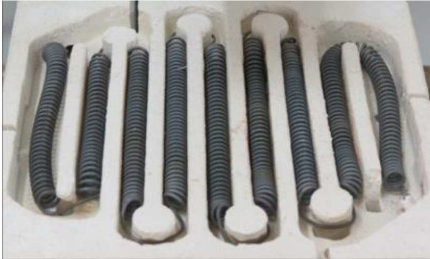
Figura 4-2 Detalhe do aquecedor com resistência de fio de Kanthal após algumas séries de utilização.
