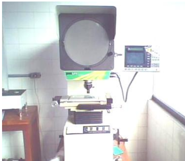
Figura12 - Projetor de perfil Nikon, utilizado para medir os diâmetros das fibras de malva (Adaptado de MONTEIRO ET AL, 2008).
