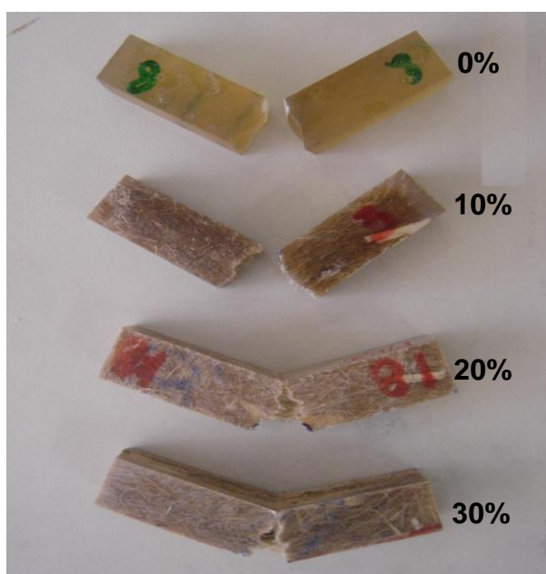
Figura 46 – Aspectos macroestruturais da ruptura por impacto Izod de compósitos de matriz poliéster com diferentes frações volumétricas de fibras de malva.
