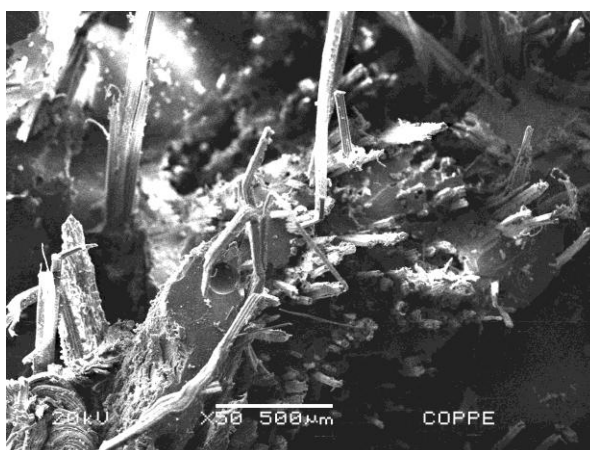
Figura 40 – Fratura por impacto do corpo de prova do compósito com 30% em volume de fibra de malva.
