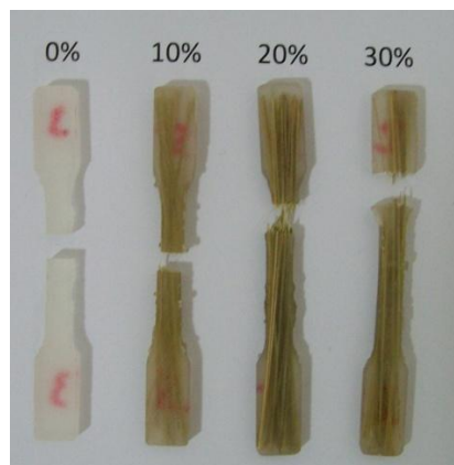
Figura 62 – Corpos de prova com matriz de poliéster reforçados com 0, 10, 20 e 30% em volume de fibras de malva, ensaiado em tração.
