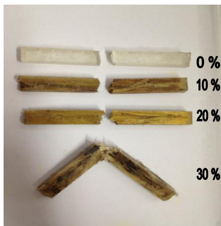
Figura 42 – Corpos de prova típicos de compósitos de matriz epóxi com diferentes frações volumétricas de fibra de malva, rompidos por impacto Charpy.
