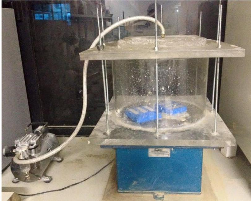
Figura 5.4. Equipamento usado para confecção dos corpos de prova.
