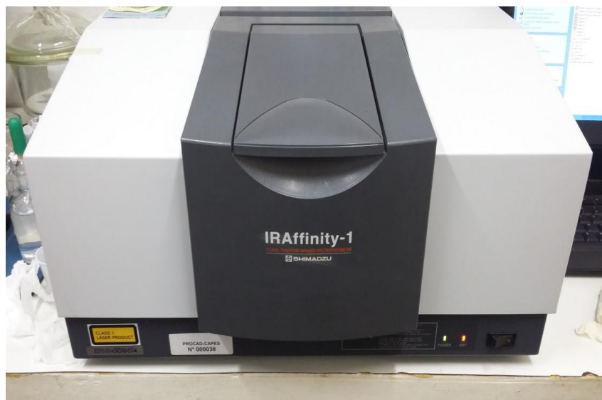
Figura 3.11 – Espectrômetro de infravermelho FTIR (LCQUI/UENF).
