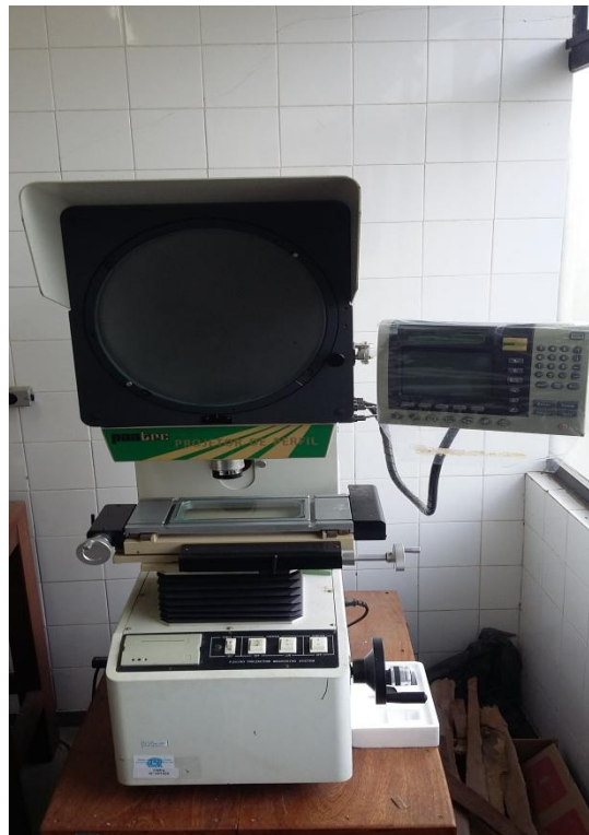
Figura 3.4 – Projetor de perfil Nikon, utilizado para medir os diâmetros das fibras de PALF LAMAV/UENF.
