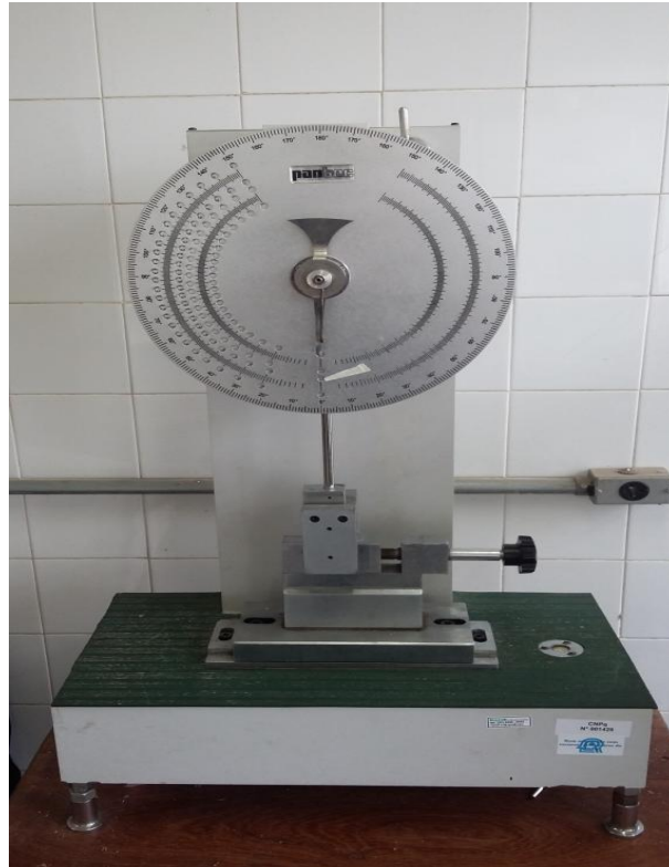
Figura 3.8 – Pêndulo de ensaio de impacto marca PANTEC, disponível no LAMAV/UENF.
