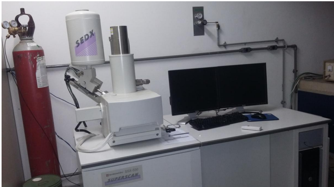
Figura 3.9 – Microscópio Eletrônico de Varredura marca Shimadzu, modelo SSX-550, disponível no LAMAV/UENF.
