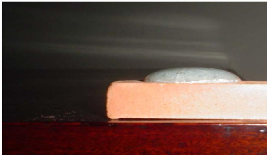
**Figura 4.30- Fotografia do vidro de tubo de TV, sinterizado a 900°C.**
