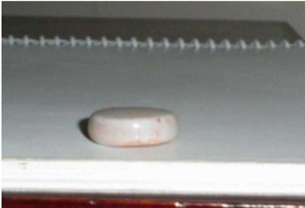
**Figura 4.31- Fotografia do vidro de tubo de televisão, sinterizado a 700°C.**
