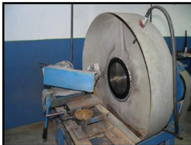
Figura 48 – Retífica usada no processo de limpeza e rebarbação das serras circulares da empresa ABRASDI.
