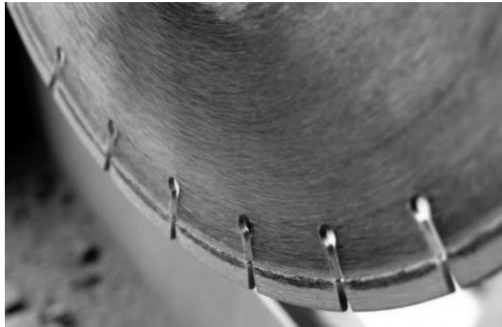
Figura 49 – Serra contendo segmentos diamantados (Robleda et al. , 2010).
