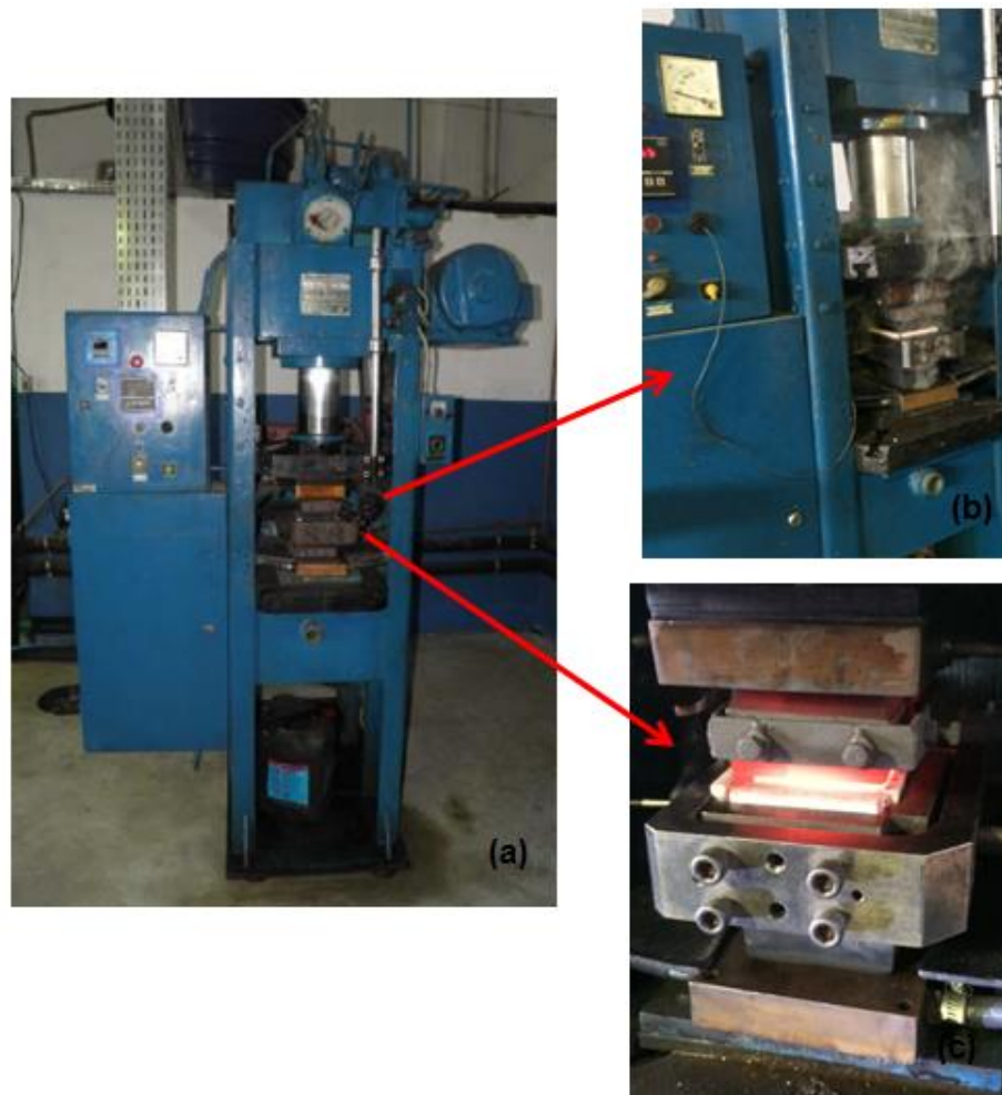
Figura 64 – Processo de sinterização (a) prensa hidráulica EKA da empresa ABRASDI (b) início do processo de sinterização (c) molde incandescente durante o processo de sinterização.
