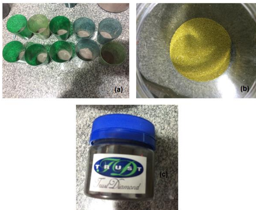
Figura 62 – (a) mistura reativa após o processo de moagem preparada nas devidas proporções para receber os materiais superduros (b) cristais de diamante e (c) cristais cBN, ambos provenientes da Diamond Trust.
