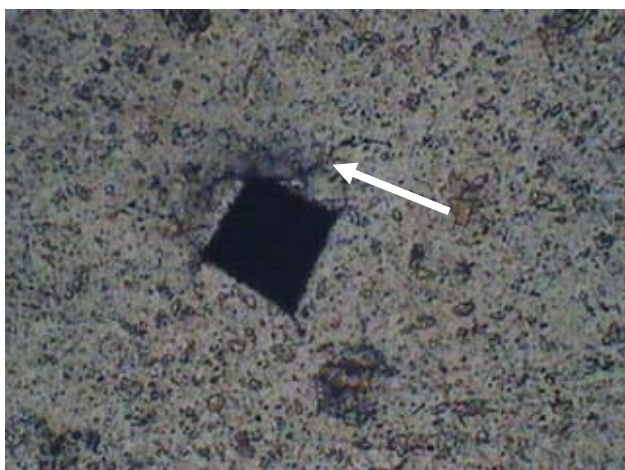
Figura 46. Indentação na amostra 15 (4 GPa/1400°C/2 minuto) em 125X de aumento.
