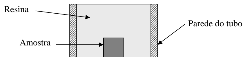
Figura 35. Corte da amostra embutida com resina em um tubo metálico.
