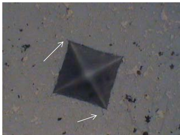
Figura 49. Indentação na amostra 0 (convencional) em 200X de aumento.
