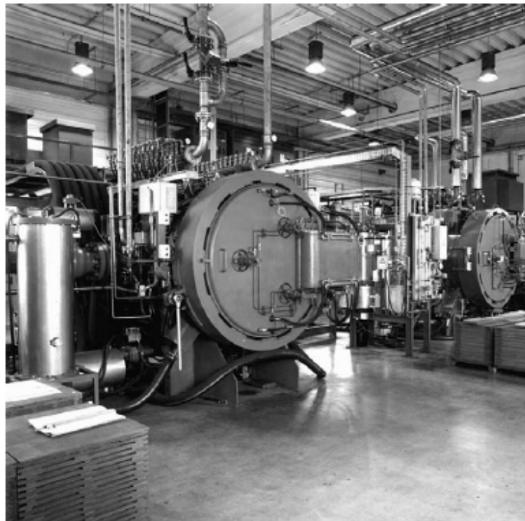
Figura 9. Fotografia de um forno HIP [Tweed, J., 2003].
