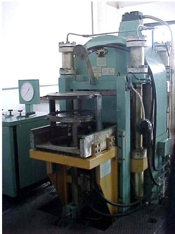
Figura 21. Prensa hidráulica especial de 2500 t.
