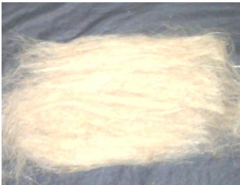
Figura 26: Fibras longas de rami como comercializadas (Fonte própria).
