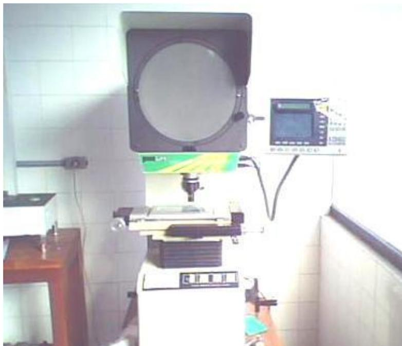
Figura 27: Projetor de perfil Nikon, utilizado para medir os diâmetros das fibras de rami (Fonte própria).
