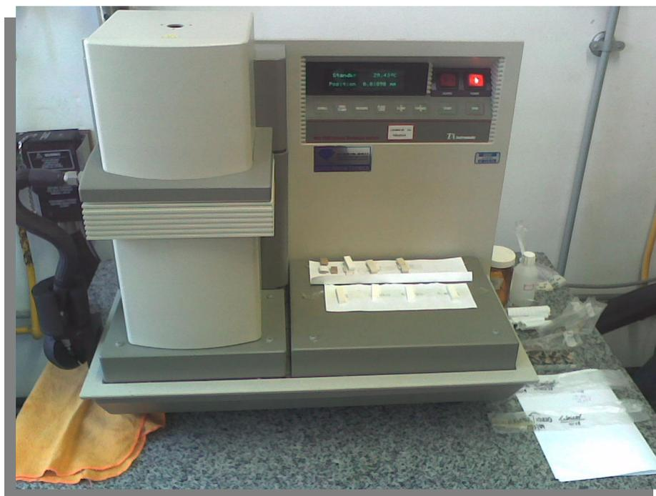
**Figura 3.12:** Equipamento de DMA da TA Instruments, modelo multi freqüência 2980
