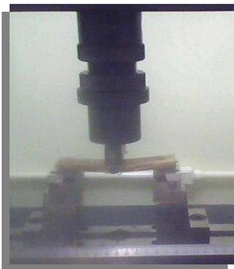
**Figura 4.21:** Ensaio de Flexão de 3 pontos com corpo de prova de piaçava.
