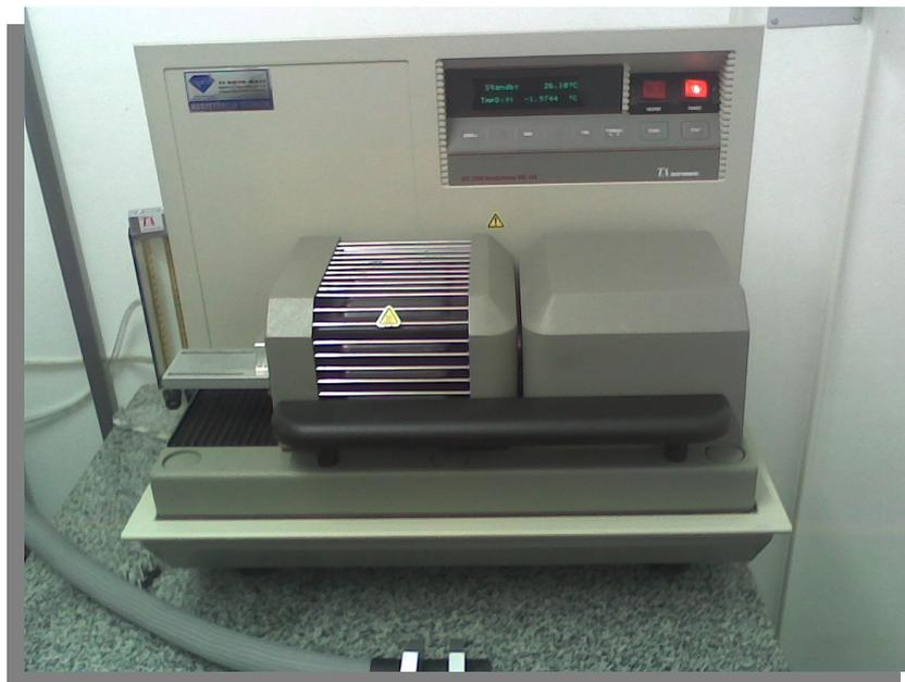
**Figura 3.13:** Equipamento de Ensaio TGA, TA Instruments modelo SDT 2926
