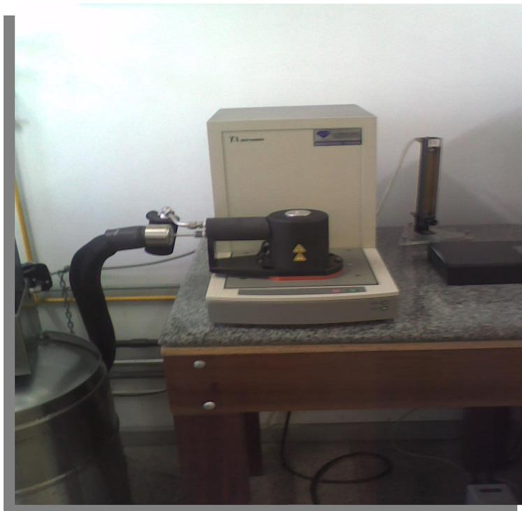
**Figura 3.14:** Máquina de Ensaio DSC, da TA Instruments Systems modelo 2910
