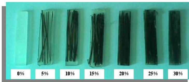
**Figura 4.36.** Corpos de prova de compósitos de fibra de piaçava com diferentes frações volumétricas, reforçando matriz epóxi, para ensaios de DMA.
