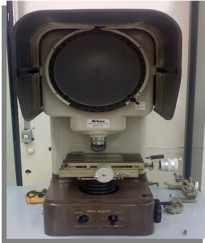
**Figura 3.3:** Projetor de perfil Nikon, utilizado para medir os diâmetros das fibras de Piaçava.
