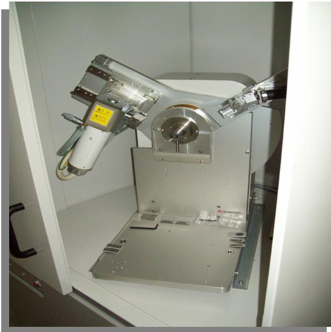
**Figura 3.5:** Difrator de raios-X Modelo Shimadzu XRD 7000
