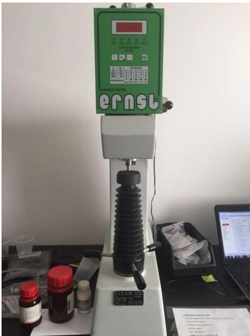
Figura 47. Durômetro utilizado para medições de dureza Rockwell B, marca ERNST, modelo NR 3D (GT Wire).
