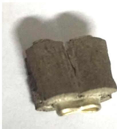
Figura 49. Fotografia da pérola após o teste com morsa.
