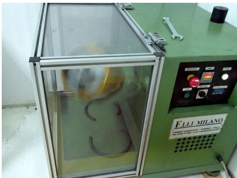
Figura 33. Misturador do tipo Turbula – Marca F. LLI Milano (GT Wire).
