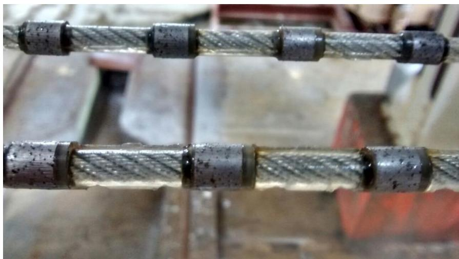
Figura ~~70~~69. Detalhe das pérolas B1 e B2 prontos para início do teste.
