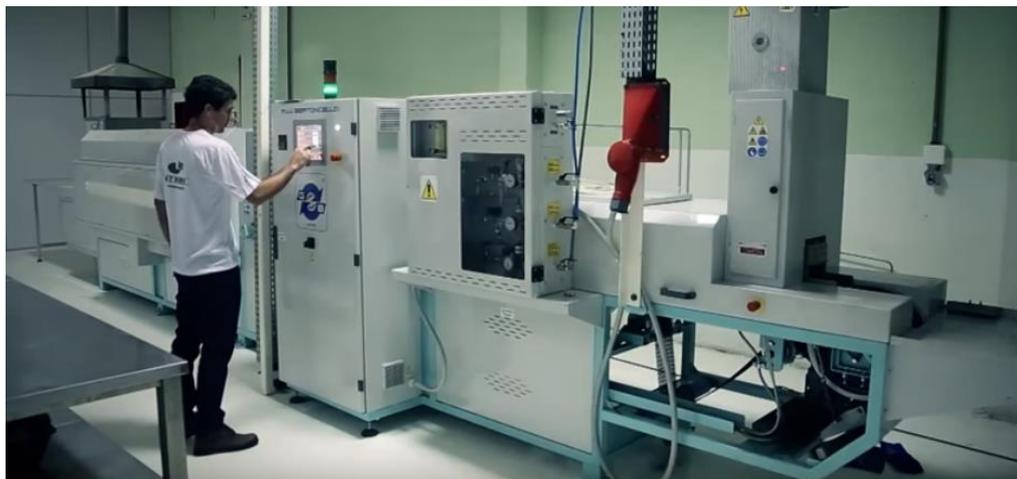
Figura 41. Forno de sinterização com atmosfera controlada (GT Wire).
