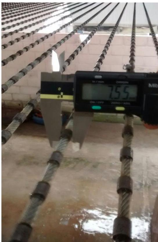
Figura 71. Diâmetro da pérola comercial após as serradas.
