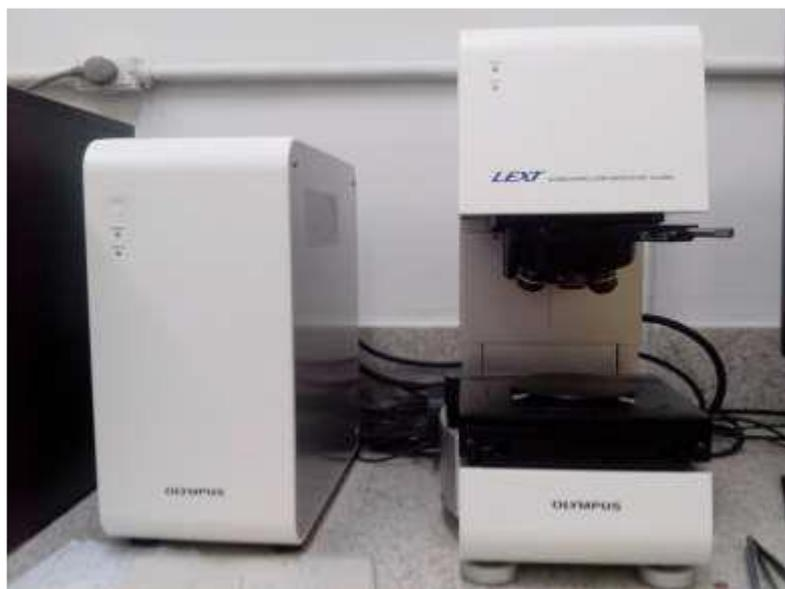
Figura 45. Microscópio confocal a laser Olympus modelo LEXT OLS4000 (LAMAV/UENF).
