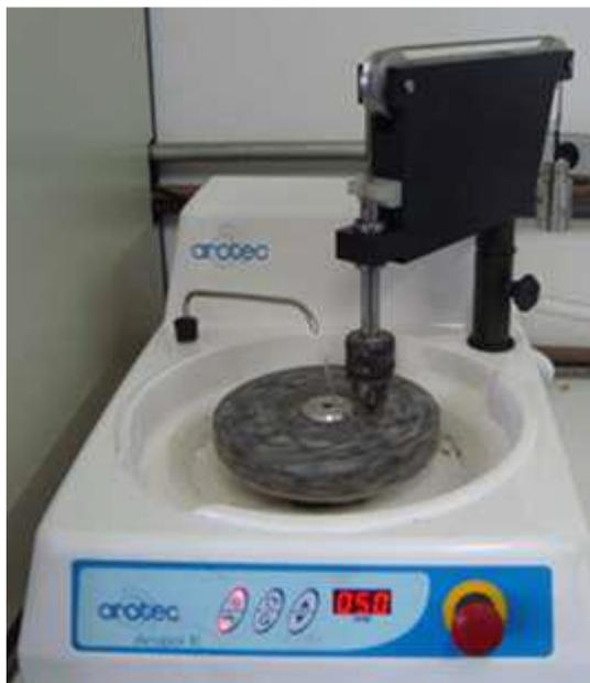
Figura 46. Abrasímetro, marca AROTEC (LAMAV/UENF).
