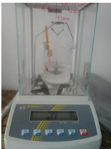
Figura 39. Balança automática utilizada para as medidas de densidade, Marca KERN, (GT Wire).
