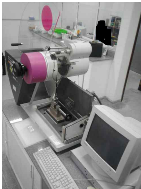
Figura 19: Pêndulo utilizado para ensaios de impacto Charpy.
