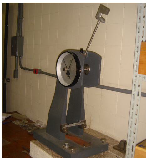
Figura 20: Pêndulo utilizado para ensaio de impacto Izod.
