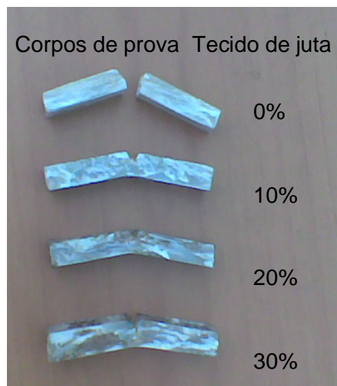
Figura 31: Aspecto dos corpos de prova rompidos por impacto Izod.
