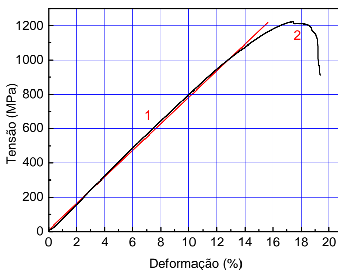
Figura 4.95 – Curva tensão x deformação da liga Cu-13,7%Al-4%Ni no estado inicial, submetida ao ensaio de deformação por compressão até atingir a fratura.
