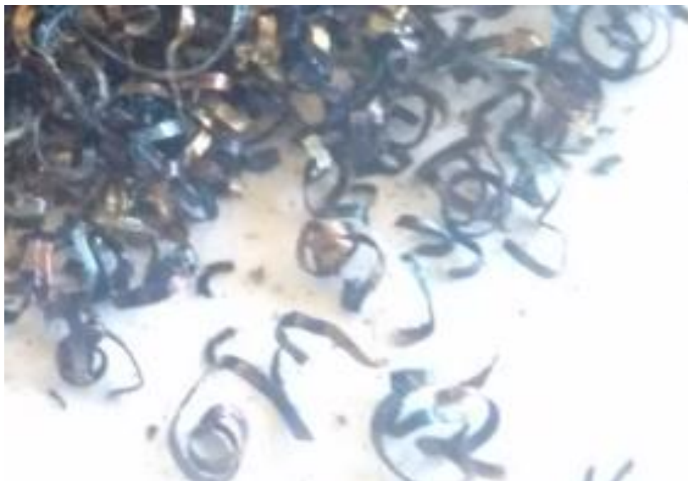
Figura 114: Fotos dos cavacos produzidos na usinagem do aço 4140 pela pastilha de WC.
