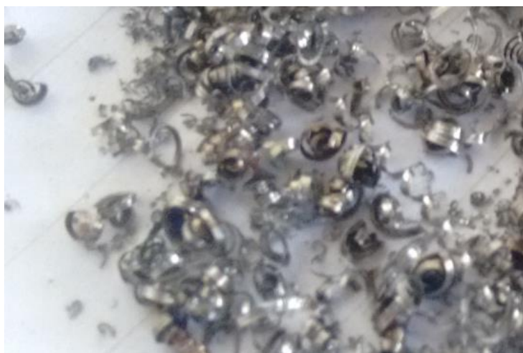
Figura 123: Fotos dos cavacos produzidos na usinagem do aço 4140 pela pastilha de dupla camada sinterizada a 1550°C.
