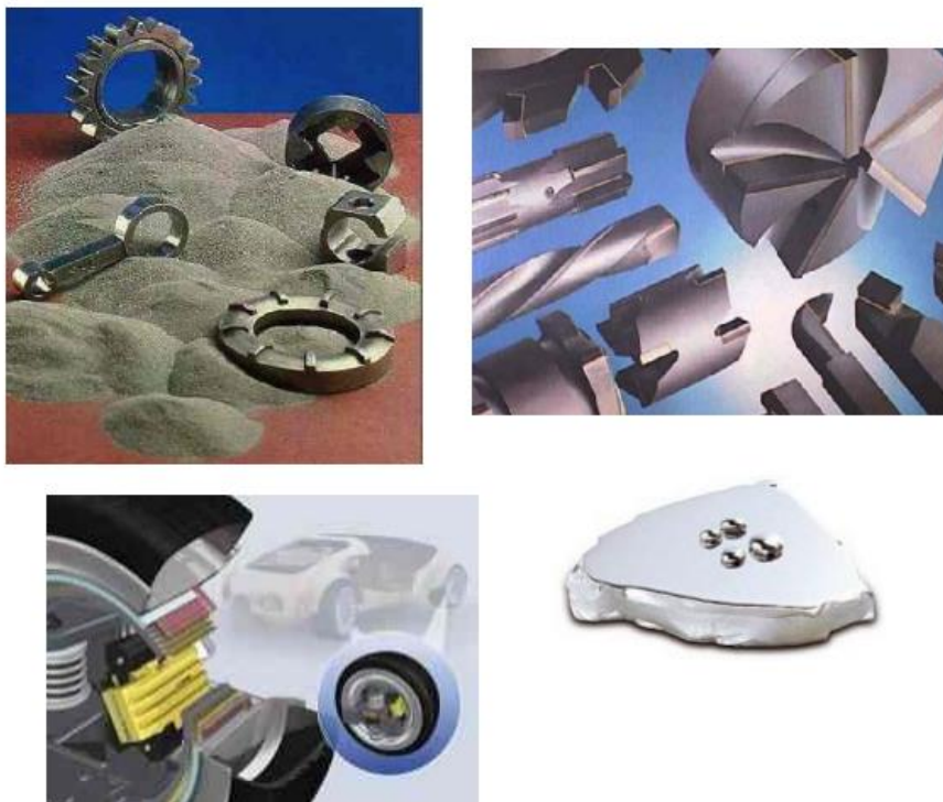
Figura 9: Algumas peças tipicamente fabricadas pelo processo de metalurgia do pó (MORO, 2007).
