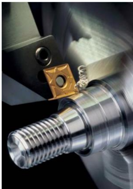
Figura 31: Operação de torneamento com inserts intercambiáveis (SOUZA, 2011).
