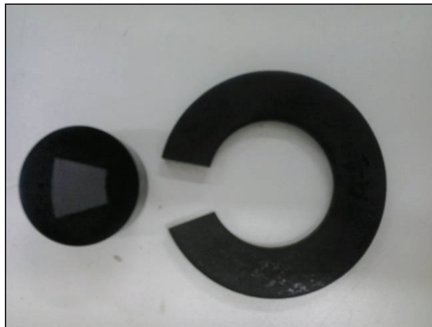
Figura (4.2) – Amostras embutidas (arruela).
