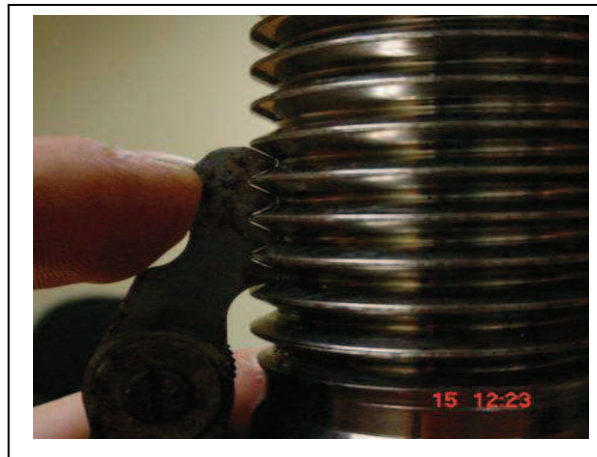
Figura (2.5) – Identificação do passo de rosca.
