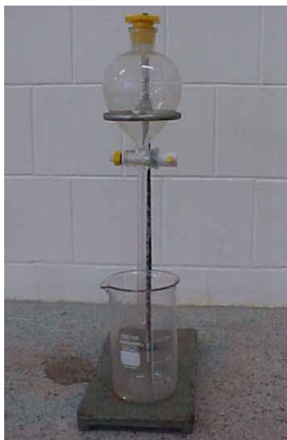
Figura 5.4 – Esquema para separação de materiais em fase líquida com diferentes densidades.
