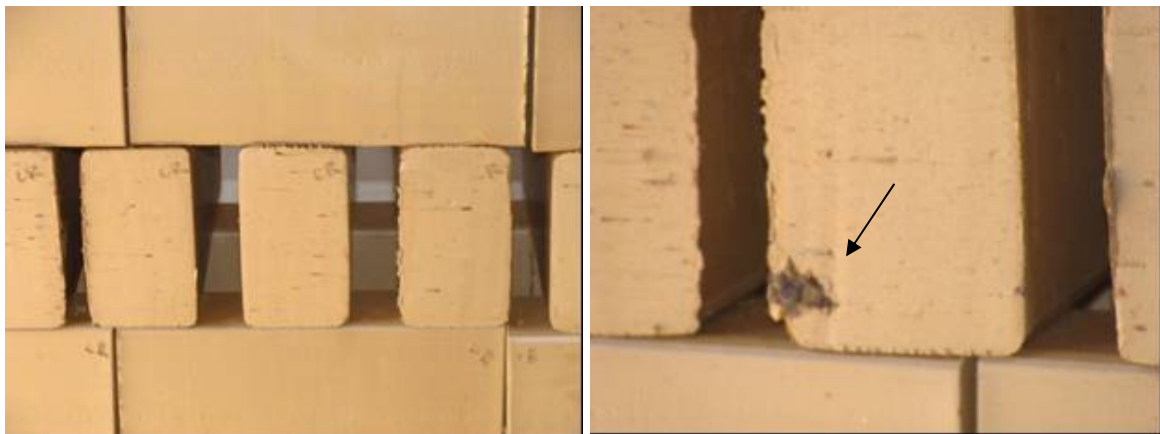
Figura 6.44 - Tijolos maciços em processo de secagem.
