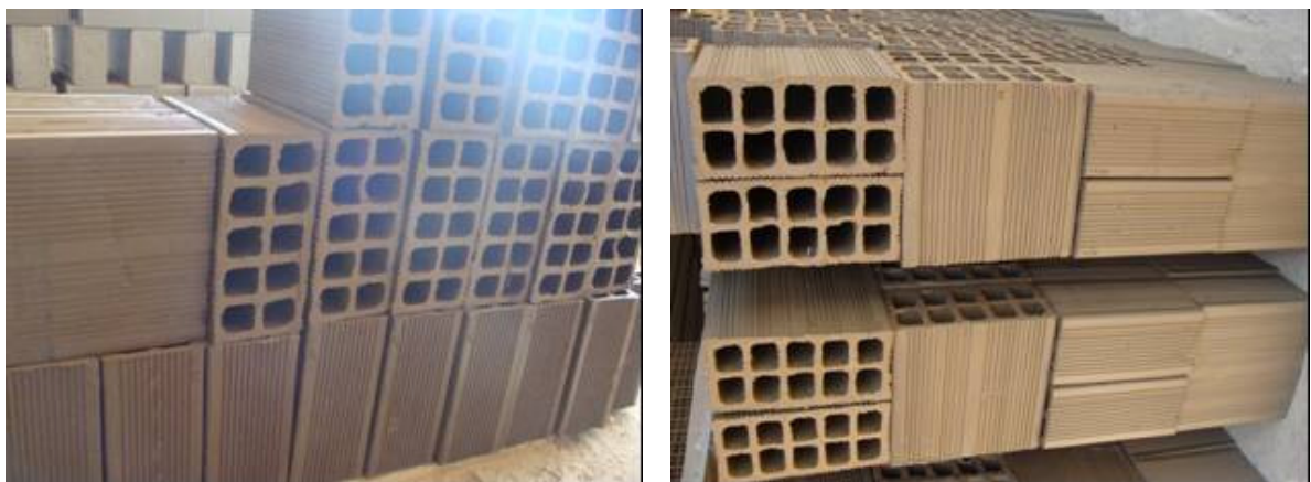
Figura 6.45 - Blocos de vedação em processo de secagem.
