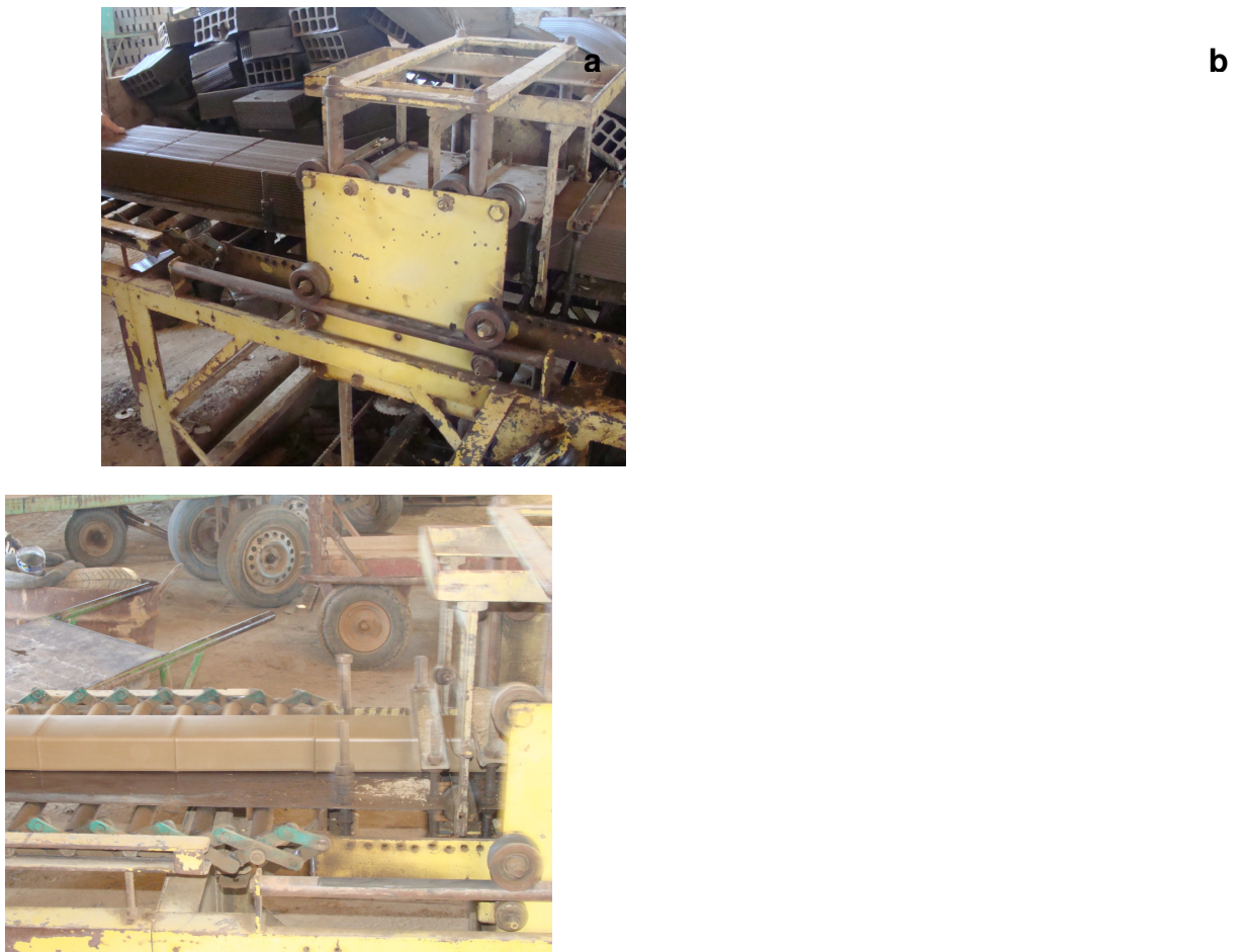
Figura 5.10 – Produção de (a) blocos de vedação e (b) maços com 10% em massa de PPE.
