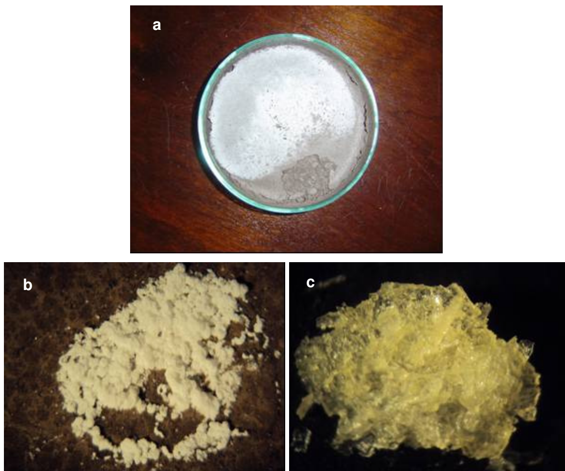
Figura 6.47 – Resíduo da vaporização do extrato aquoso do PPE: (a) na superfície do PPE; (b) e (c) por MO.
