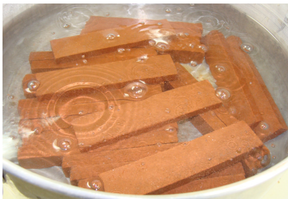
Figura 5.8 – Peças durante ebulição para determinação da absorção de água.
