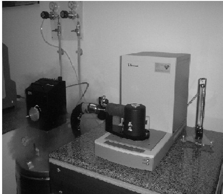
Figura 24 – Equipamento de Calorimetria Diferencial Exploratória, DSC 2910 da TA Instruments.
