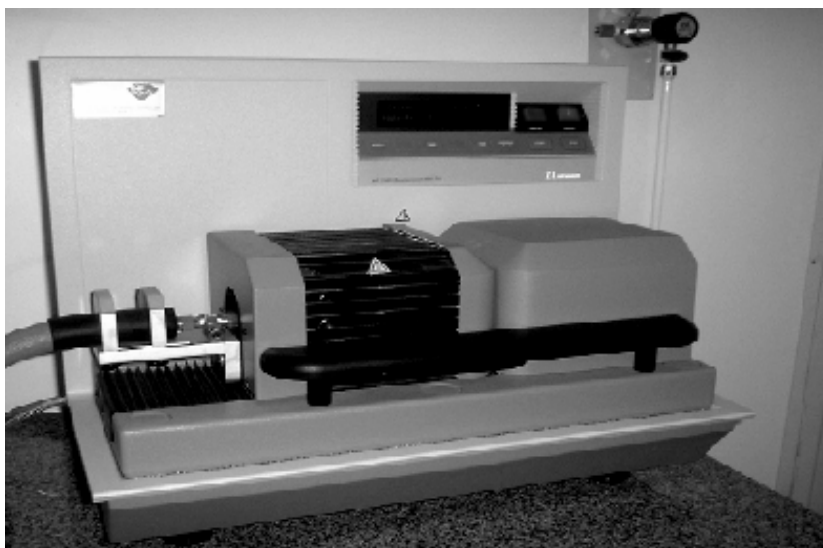
Figura 27 – Equipamento Termogravimétrico, SDT 2960 da TA Instruments.
