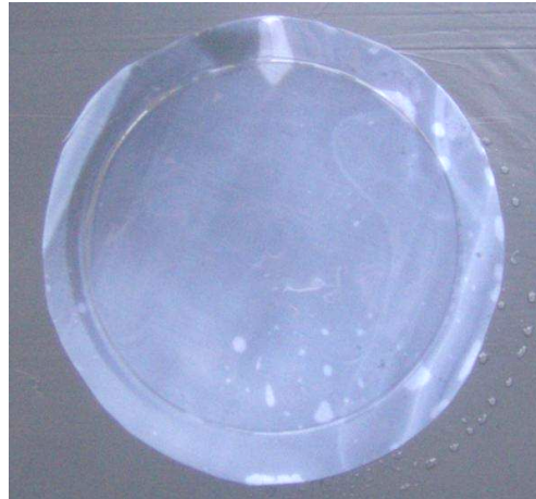
Figura 58 – Membrana porosa CP/P3(HB-22%HV) formulada por inversão de fase.
