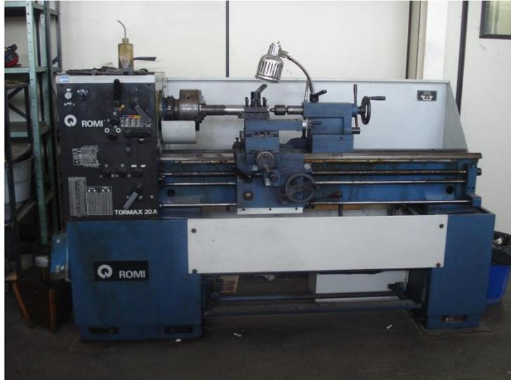
Figura 61 – Torno mecânico universal Romi Tormax 20A.
