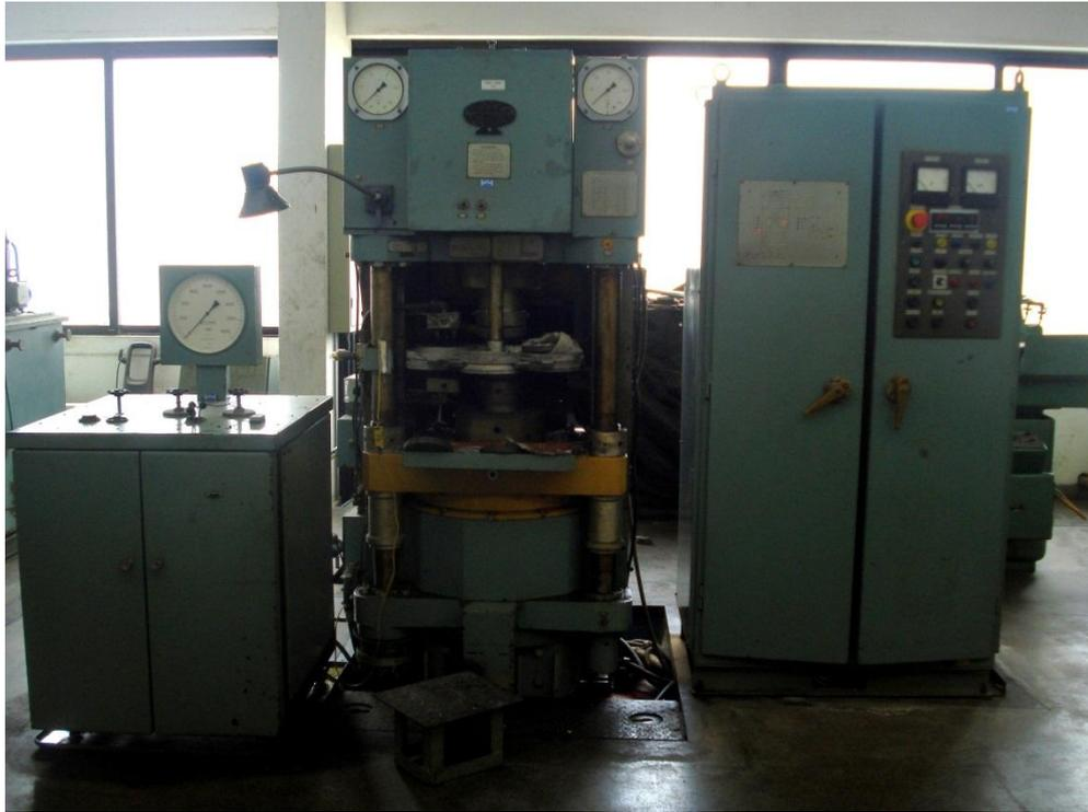
Figura 58 – Prensa hidráulica especial de 630 toneladas de força, modelo D0138B.
