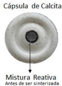
Figura 53 – Cápsula deformável montada (sem a tampa de grafite).
