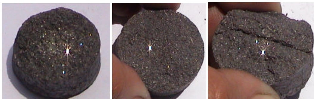
Figura 6. 59 – Aglomerados obtidos com as cápsulas importadas submetidas a 100MPa de pressão hidráulica, durante 10min e com corrente inicial de aquecimento de 875A. (Diâmetro médio dos aglomerados: 33mm). A distribuição dos diamantes concentrou-se no centro do aglomerado.
