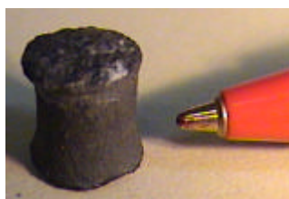
Figura 6. 62 – Aglomerado obtido após a sinterização a 8GPa e temperaturas superiores a 1400°C. (Diâmetro médio e altura média do aglomerado igual a 5,0mm e 6,50mm, respectivamente).
