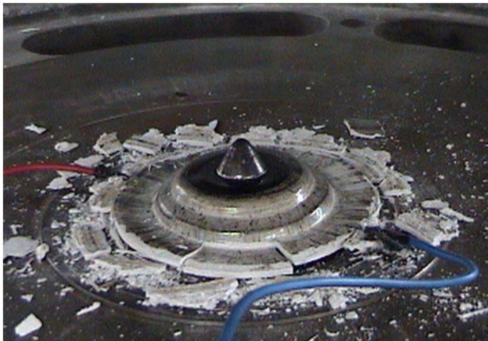
Figura 6. 52 – Cápsula deformável com o termopar montado em seu interior. Fotografia obtida após o ensaio de calibração de temperatura.
