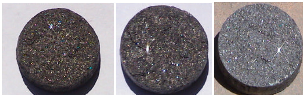
Figura 6. 60 – Aglomerados obtidos com as cápsulas nacionais submetidas a 100MPa de pressão hidráulica, durante 10min e com corrente inicial de aquecimento de 875A. (Diâmetro médio dos aglomerados: 33mm). A distribuição dos diamantes foi mais homogênea.
