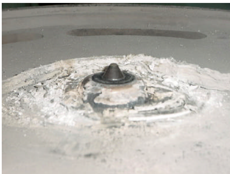
Figura 6. 38 – Fotografia de uma cápsula que explodiu dentro de um DAP tipo bigorna com concavidade cônica variáveis durante a aplicação da alta pressão e alta temperatura. O DAP foi permanentemente danificado.
