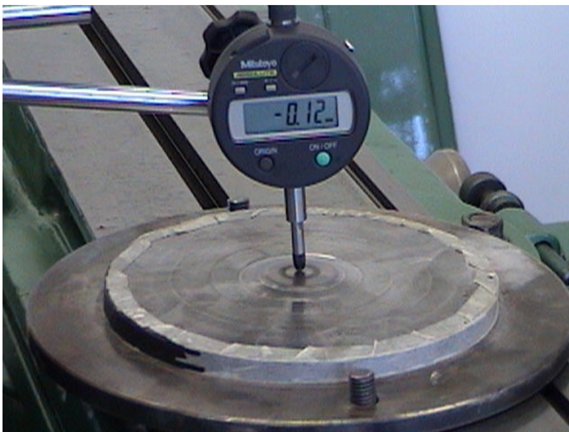
Figura 6. 37 – Deformação plástica de 0,12mm causada durante o alívio de pressão de uma amostra de aragonita que havia sido submetida à pressão hidráulica de 3,5MPa.
