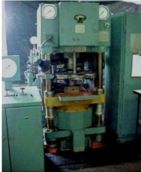
**Figura 19:** Prensa Hidráulica 630 t.
