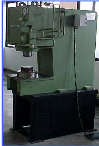
**Figura 22:** Prensa hidráulica utilizada para compactação da cápsula.
