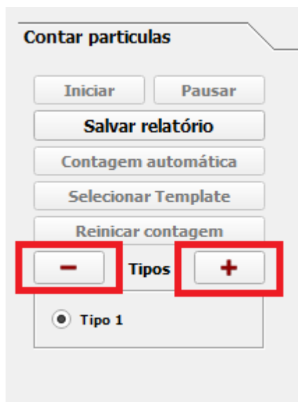
Figura 4.17 - Parte do painel de funcionalidades presente no lado esquerdo da tela inicial do Quanto com destaque nos botões incluir e excluir tipos.
