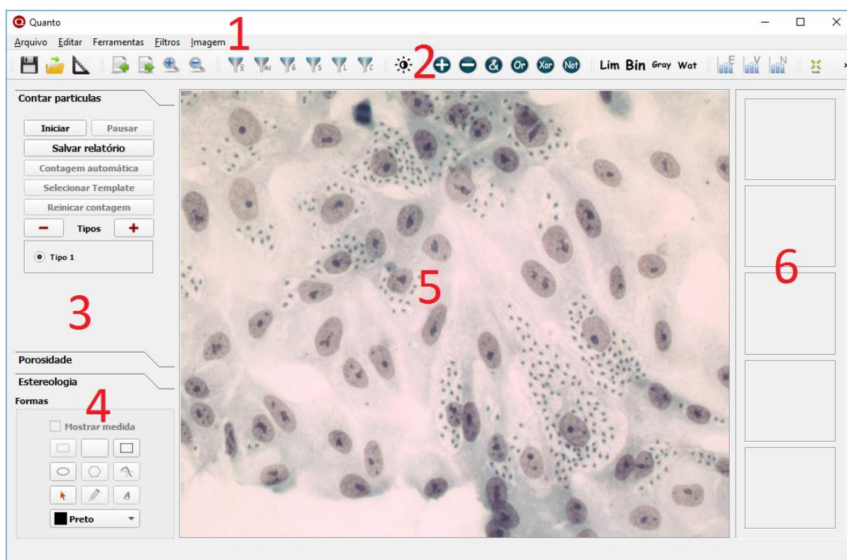
Figura 4.1 - Interface gráfica do Quanto. 1) barra de menu; 2) caixas de ferramentas; 3) painel lateral de funcionalidades; 4) ferramentas de criação de formas; 5) área de trabalho; 6) painel de snapshot .
