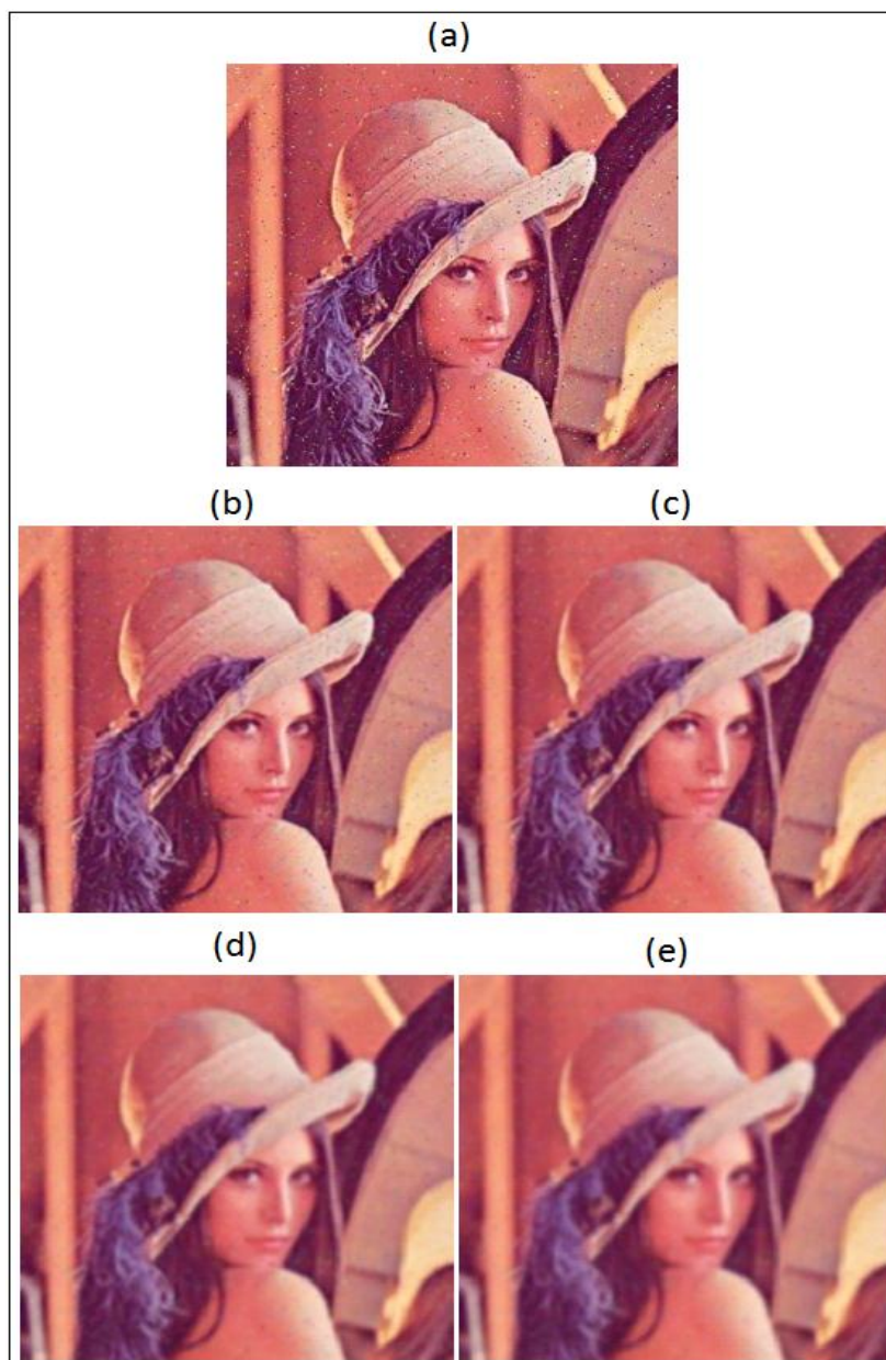
Figura 2.18 - Aplicação do filtro Gaussiano; (a) Imagem original;(b) resultado do filtro com máscara 3x3; (c) resultado do filtro com máscara 5x5; (d) resultado do filtro com máscara 7x7; (e) resultado do filtro com máscara 9x9.
