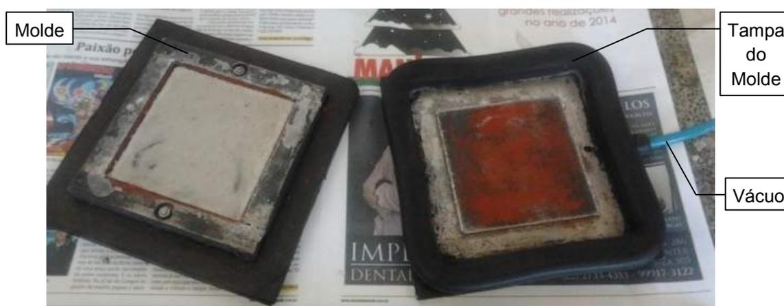
**Figura 5.3.** Molde a vácuo utilizado na produção das placas
