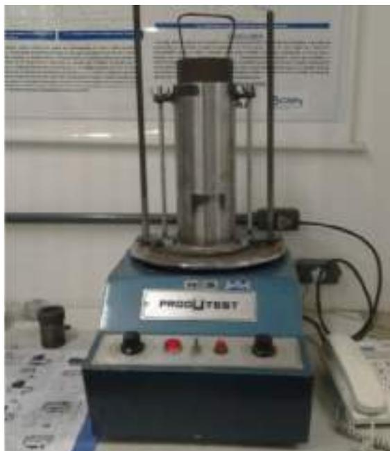
**Figura 5.1.** Aparato utilizado na determinação da densidade aparente seca das partículas de mármore
