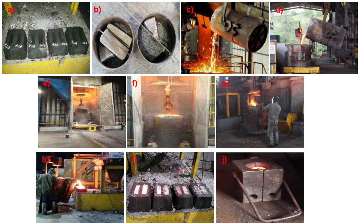
Figura 36: a) preparação dos moldes, b) Fe-Si 75% e Mg, c) chegada do metal-base e retirada da escória, d) vazamento do metal na panela de tratamento e início da inoculação, e) primeira nodulização e pós-inoculação, f) segunda nodulização e pós-inoculação, g) medição de temperatura, h) vazamento do metal tratado nos moldes, i) resfriamento ao ar, j) pastilha coquilhada.
