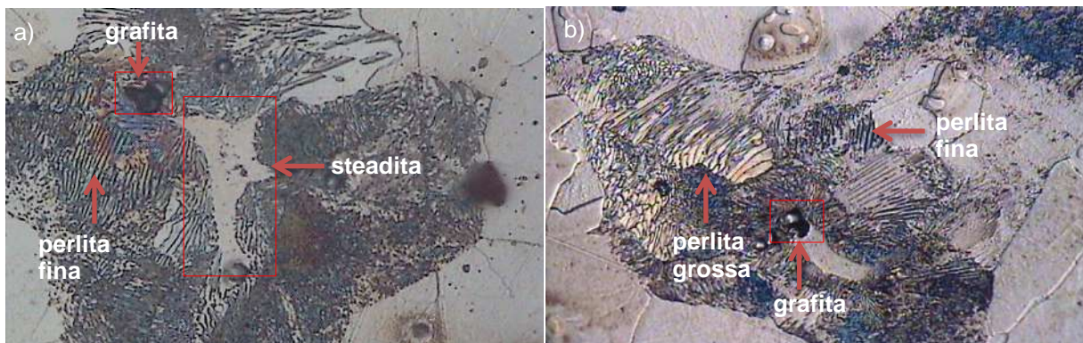
Figura 67: Regiões de perlita fina e grosseira contendo steadita e grafita. a) Liga T1 (10min/1362°C), b) liga T6 (35min/1254°C).
