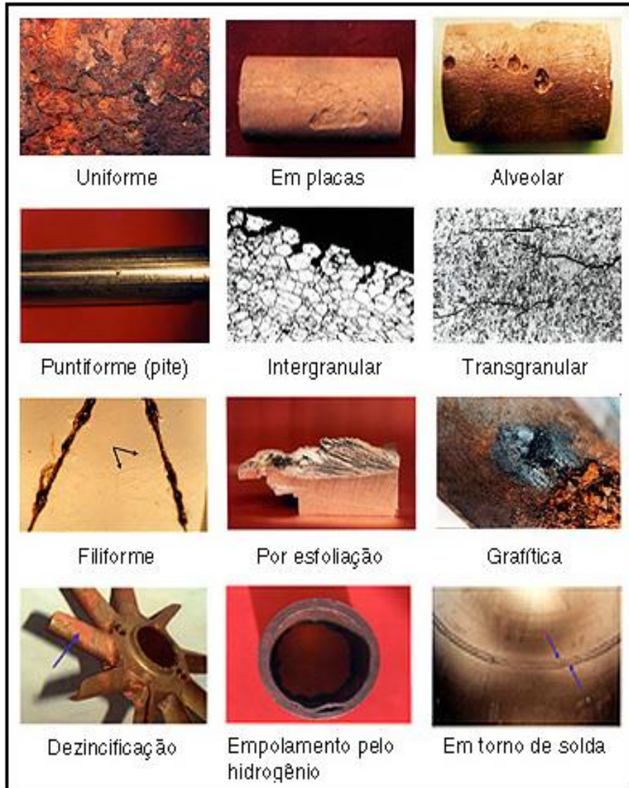
Figura 2.1: Formas de corrosão (Gentil 2003).
