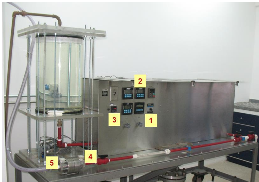
Figura 3.3 - Célula de corrosão, visão frontal. 1- Variador de frequência das bombas com função desliga, 2- Indicador de velocidade de fluxo (m/s), 3- Indicador de temperatura, 4- Sonda de resistência elétrica e 5- Sonda Galvânica.
